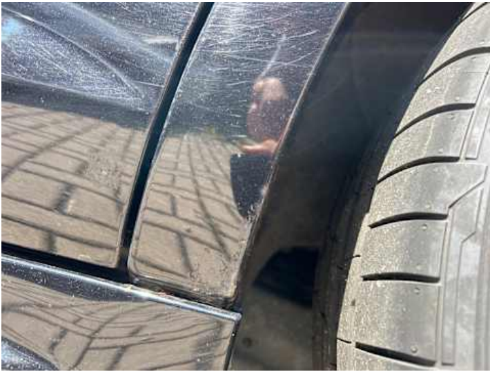
Türe hinten links (Rost)
