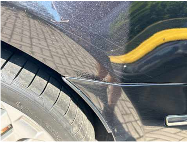
Seitenteil hinten links (Rost)
