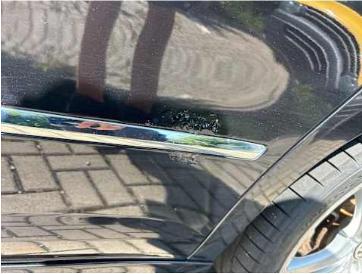
Türe hinten links (Rost)
