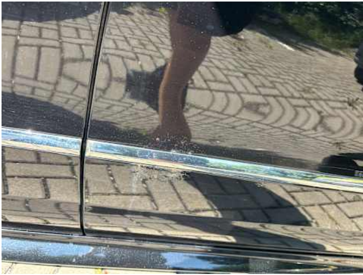
Türe hinten links (Rost)
