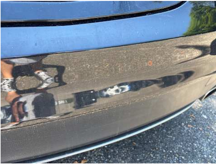
Stoßstange hinten (Verformung)
