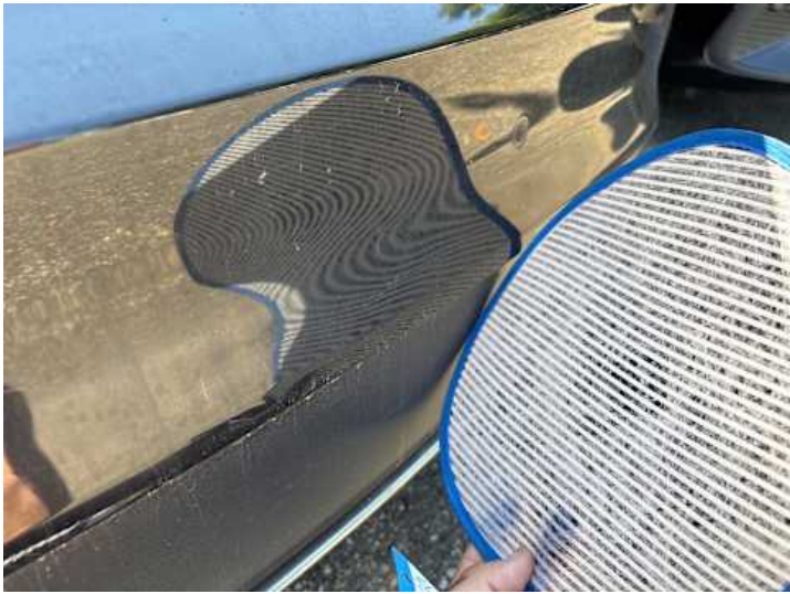
Stoßstange hinten (Verformung)
