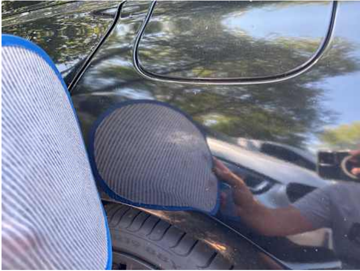
Seitenteil hinten links (Anderer Schaden): Nachlackierung Orangenhaut
