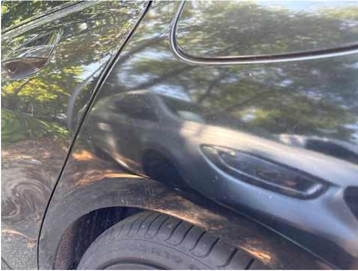
Seitenteil hinten links (Anderer Schaden): Nachlackierung Orangenhaut
