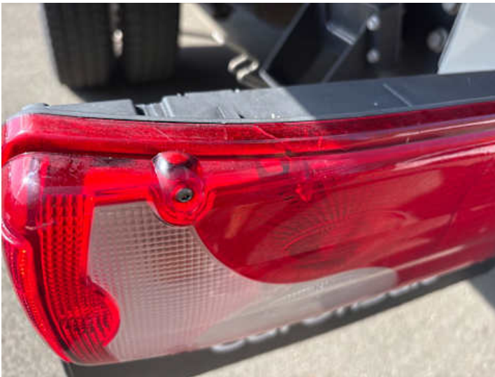
Rücklicht (links) (Riss/Bruch)
