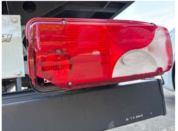
Rücklicht (rechts) (Riss/Bruch)
