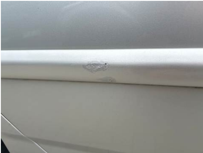
Türe hinten rechts (Lackschaden, Rost)
