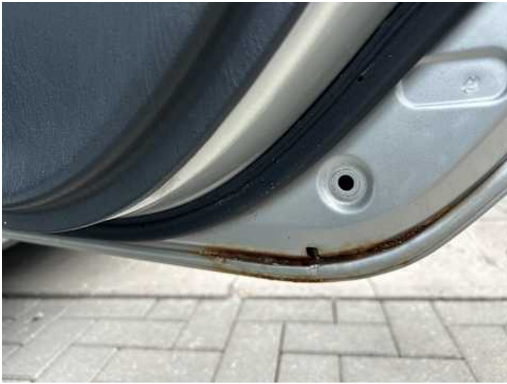
Türe hinten rechts (Lackschaden, Rost)
