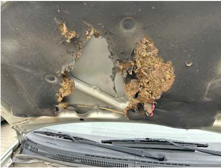
Motorhaube (Anderer Schaden): Dämmmatte beschädigt
