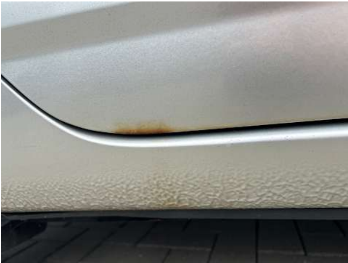
Türe hinten rechts (Lackschaden, Rost)
