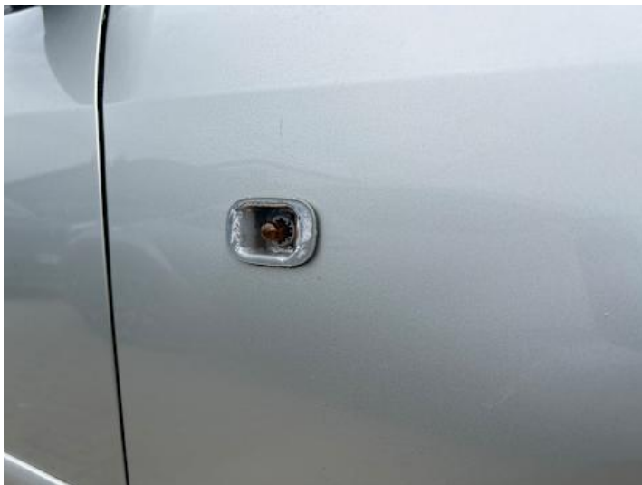
Kotflügel vorne rechts (Anderer Schaden): Blinker beschädigt
