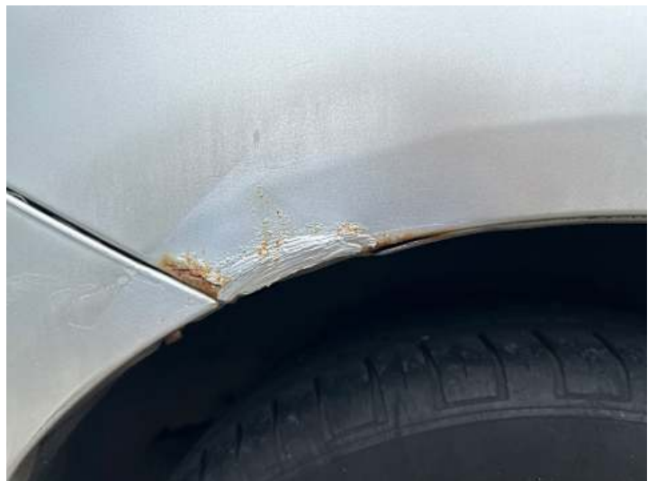
Seitenteil hinten rechts (Rost)
