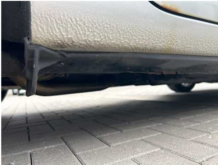
Schweller rechts (Kratzer, Rost)
