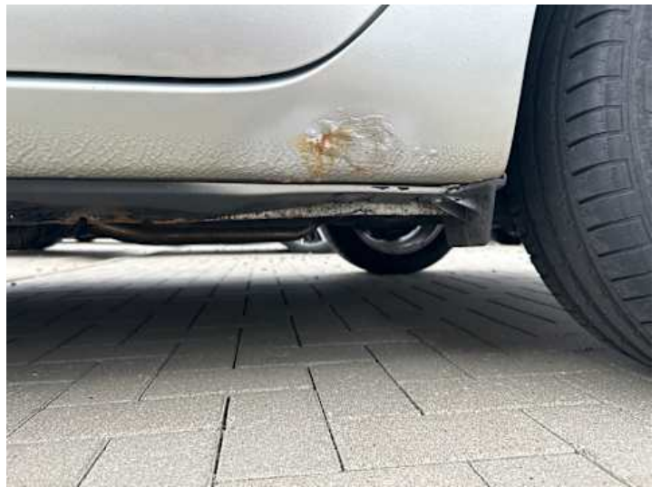
Schweller links (Kratzer, Rost)
