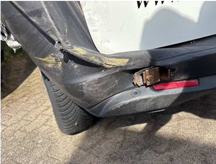
Stoßstange hinten (Riss/Bruch, Verformung, Kratzer)
