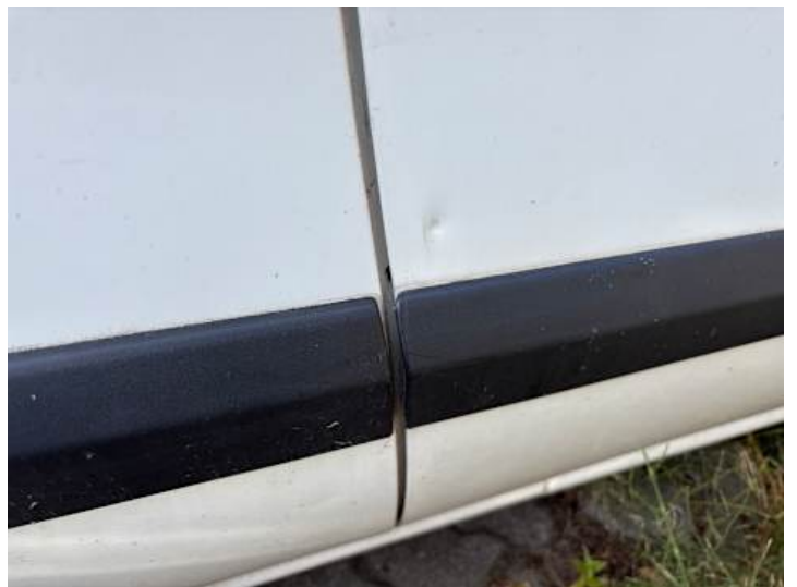
Beifahrtür (Kratzer, Delle)
