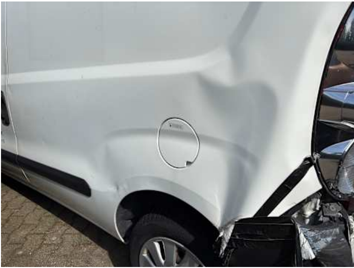
Seitenteil hinten links (Verformung, Kratzer)
