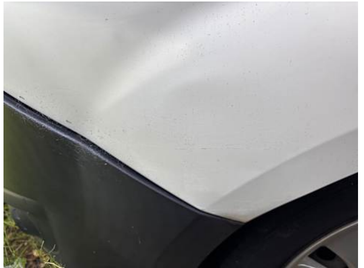
Kotflügel vorne links (Kratzer, Verformung)
