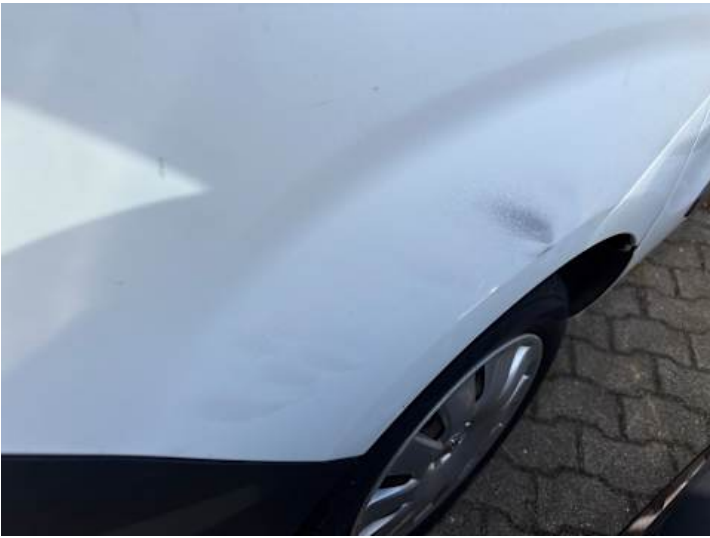
Seitenteil hinten rechts (Lackschaden, Kratzer)
