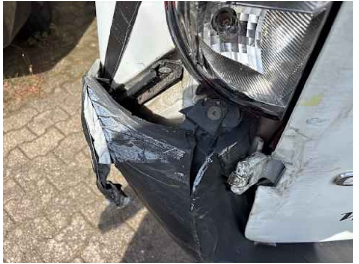
Stoßstange hinten (Riss/Bruch, Verformung, Kratzer)
