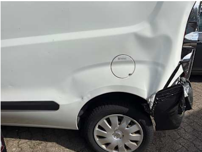
Seitenteil hinten links (Verformung, Kratzer)
