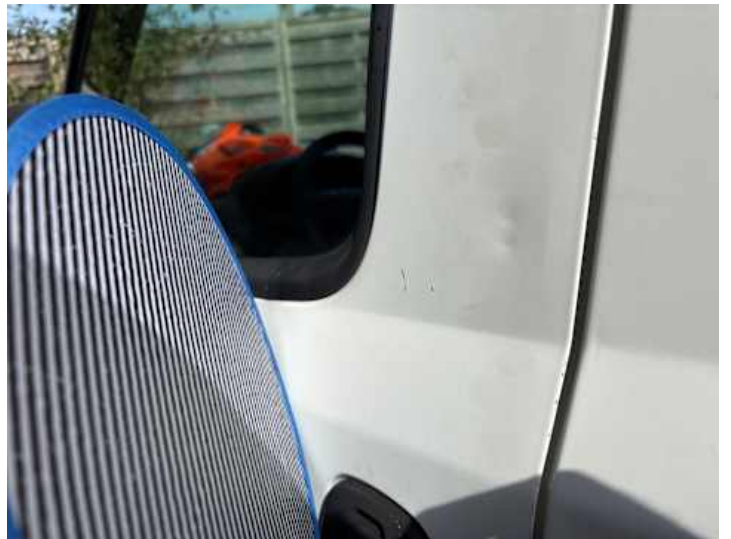
Fahrtür (Kratzer, Delle)
