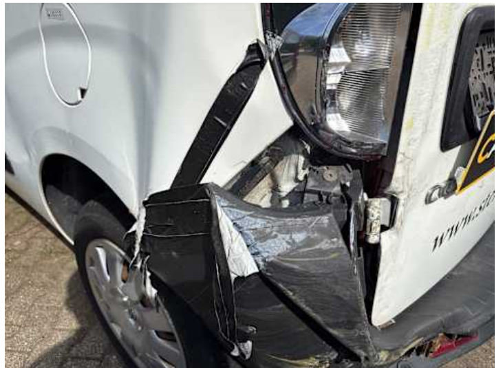
Seitenteil hinten links (Verformung, Kratzer)
