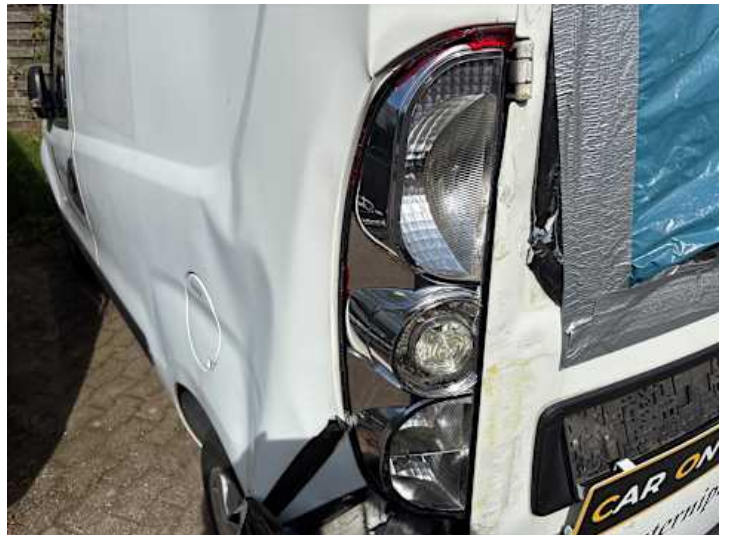
Rücklicht (links) (Riss/Bruch)
