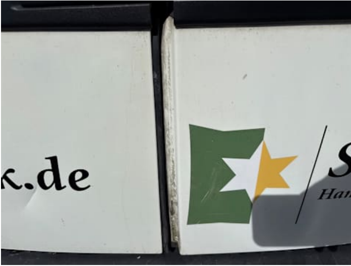
Heckklappe (Spaltmaße ungenau, Kratzer)
