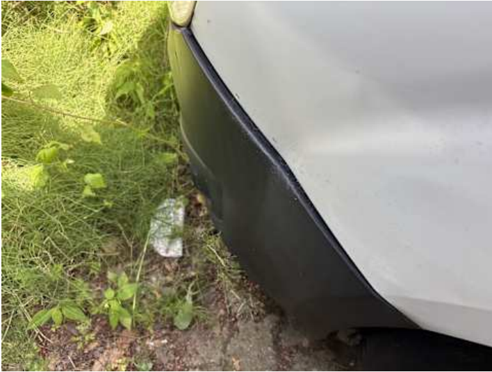
Stoßstange vorne (Spaltmaße ungenau)
