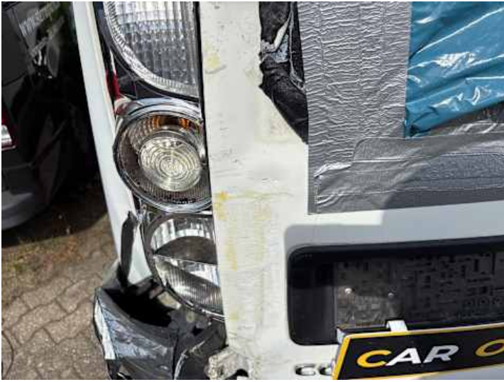
Heckklappe (Verformung, Kratzer, Spaltmaße ungenau)
