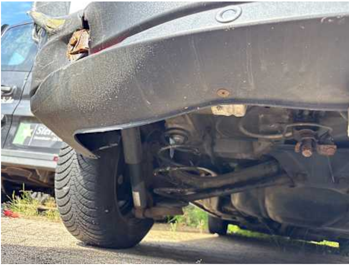
Stoßstange hinten (Riss/Bruch, Verformung, Kratzer)
