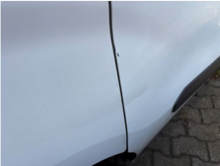
Türe hinten rechts (Kratzer, Verformung)
