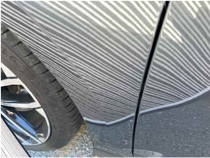
Kotflügel vorne links (Verformung)
