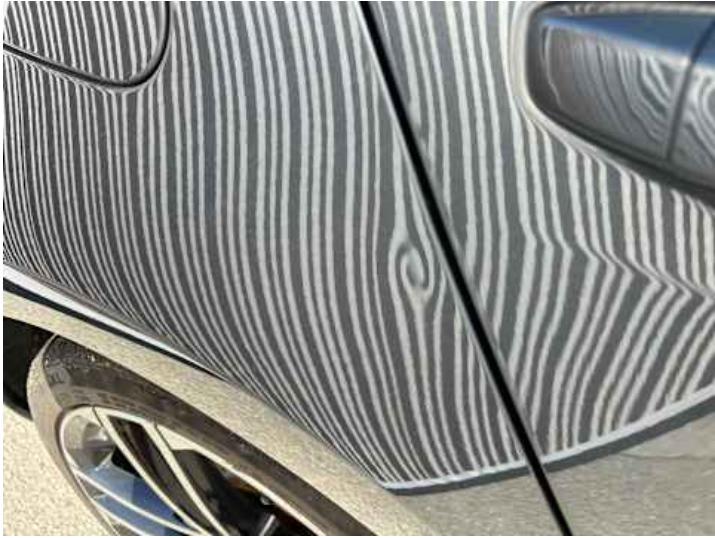
Seitenteil hinten rechts (Verformung)
