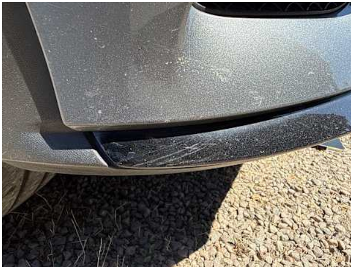
Stoßstange vorne (Spaltmaße ungenau, Kratzer)
