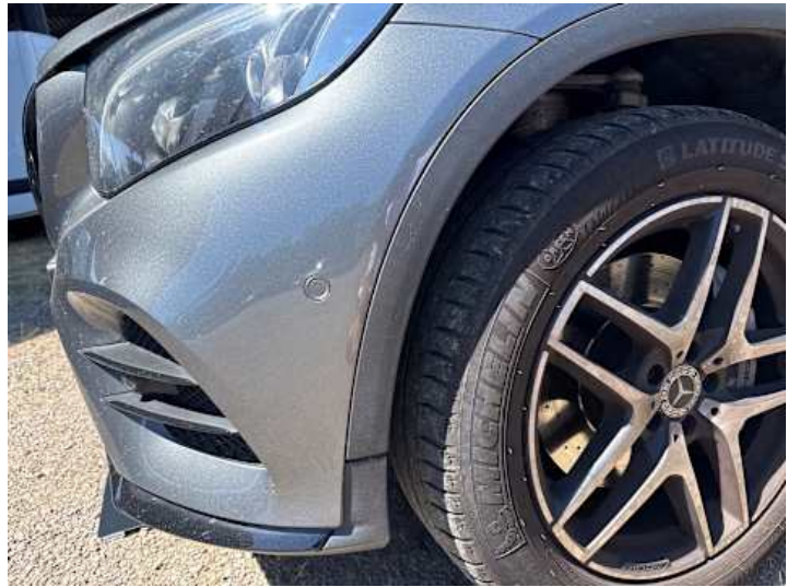
Stoßstange vorne (Spaltmaße ungenau)
