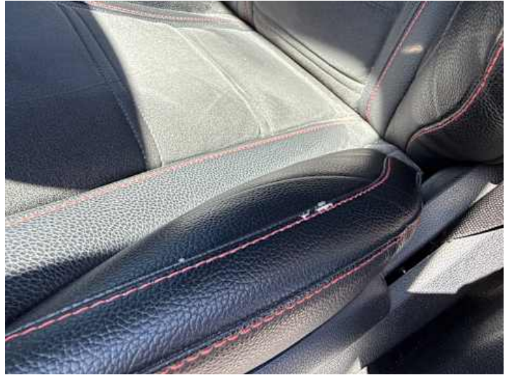
Innenraum (Verschleiß, Riss/Bruch)
