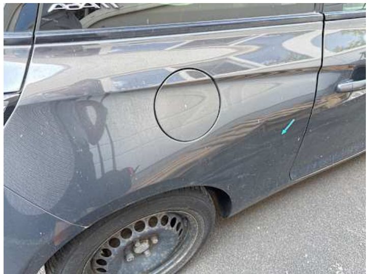
Seitenteil hinten rechts (Delle, Lackschaden)
