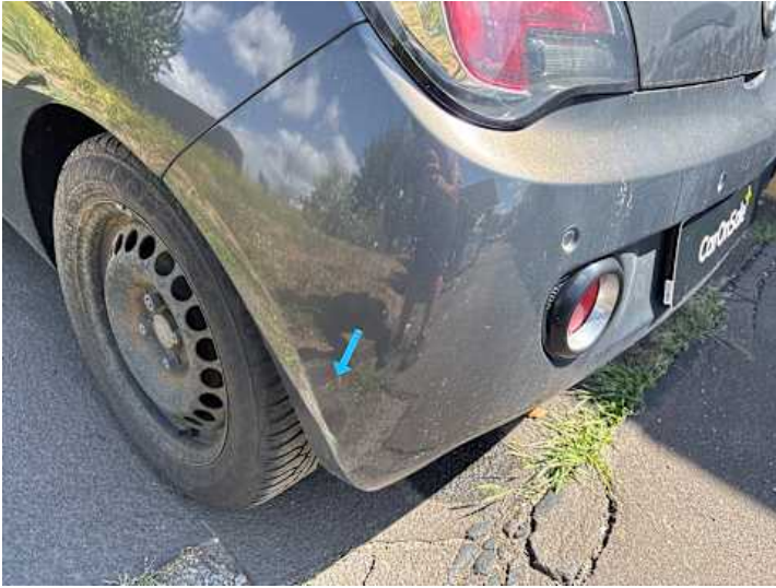
Stoßstange hinten (Lackschaden)
