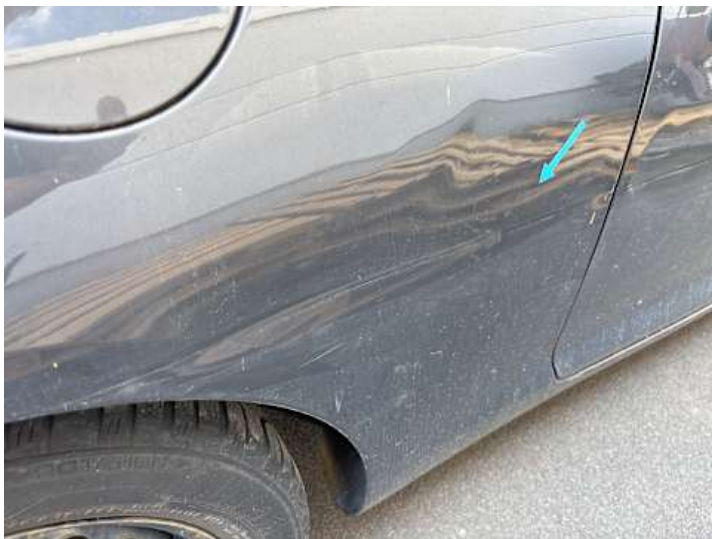
Seitenteil hinten rechts (Delle, Lackschaden)
