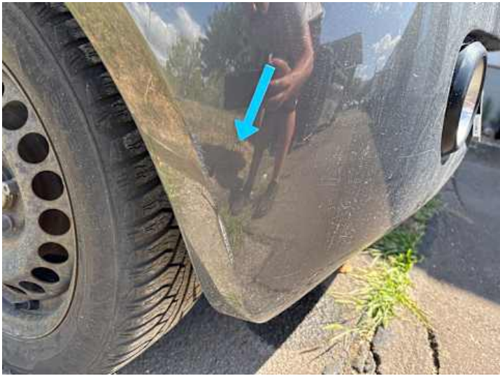
Stoßstange hinten (Lackschaden)
