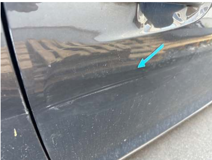
Beifahrertür (Delle, Lackschaden)
