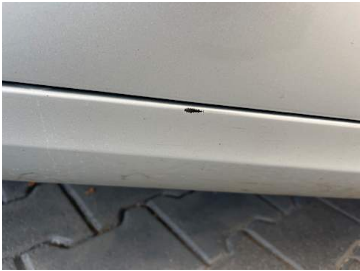
Schweller rechts (Lackschaden)
