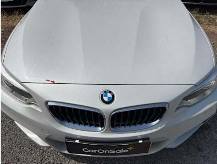
Motorhaube (Unsachgemäß instand gesetzt, Steinschlag)
