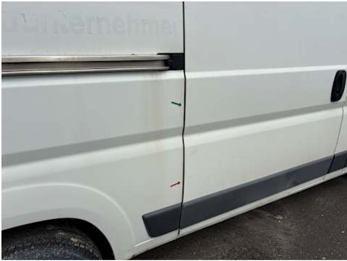
Türe hinten rechts (Spaltmaße ungenau)
