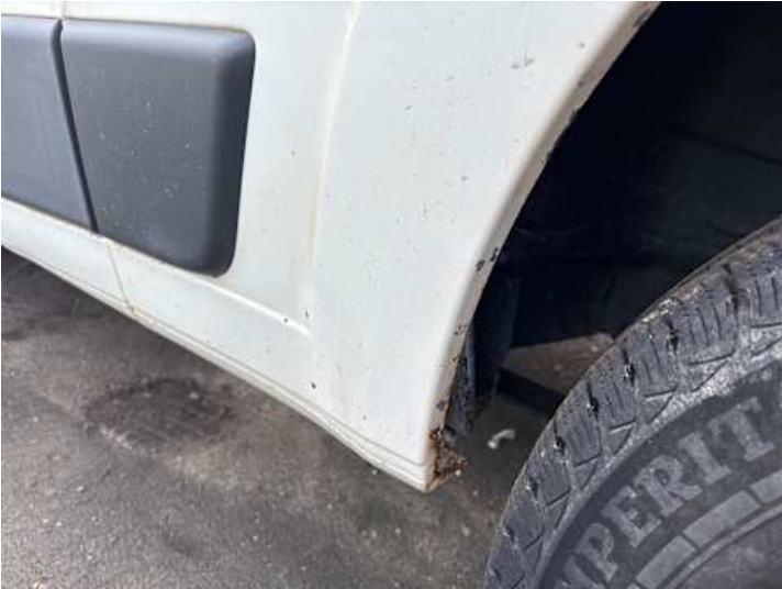
Seitenteil hinten links (Rost, Lackschaden, Kratzer)
