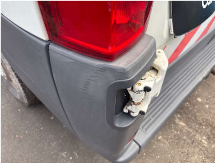
Stoßstange hinten (Kratzer, Verformung)
