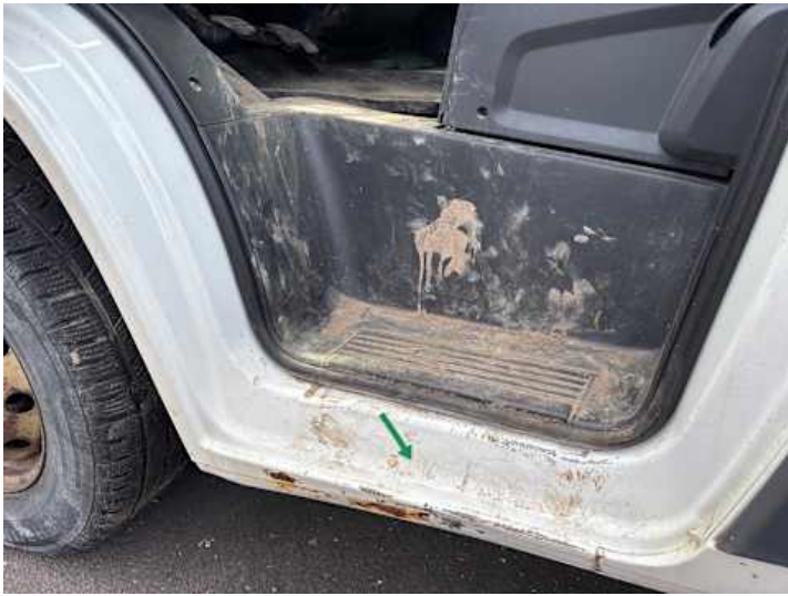
Schweller links (Kratzer, Lackschaden, Rost)
