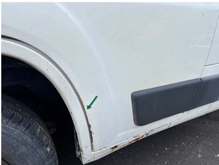
Fahrertür (Rost, Lackschaden)
