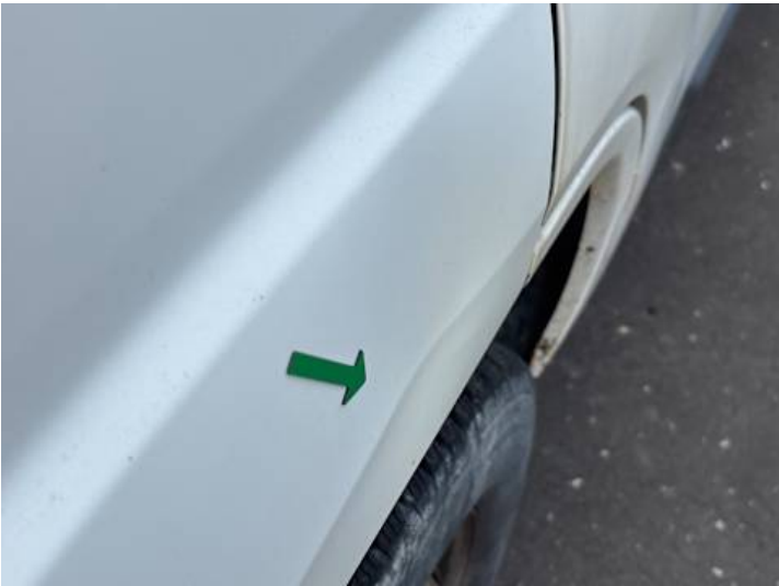
Kotflügel vorne links (Verformung)
