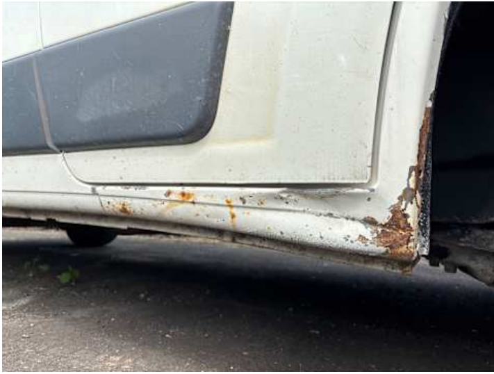
Schweller rechts (Lackschaden, Kratzer, Rost, Verformung)
