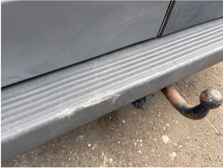
Stoßstange hinten (Kratzer, Verformung)
