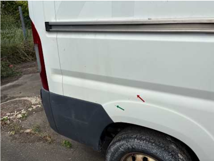
Seitenteil hinten rechts (Lackschaden)
