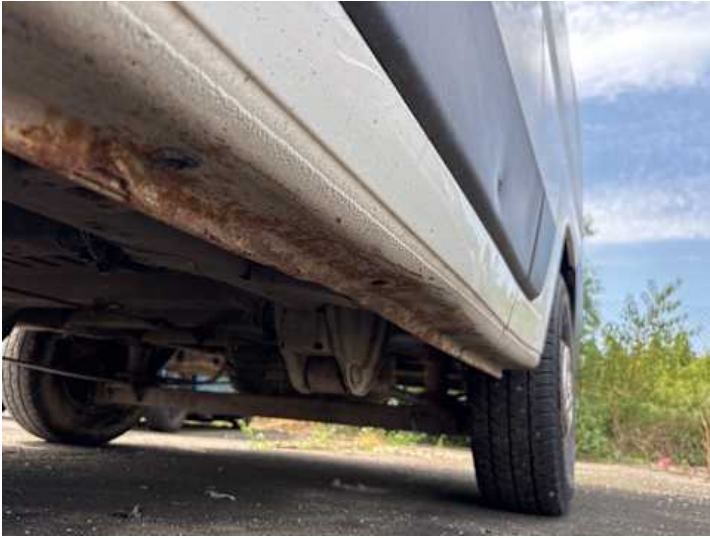
Schweller links (Verformung)
