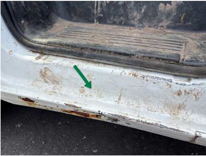
Schweller links (Kratzer, Lackschaden, Rost)
