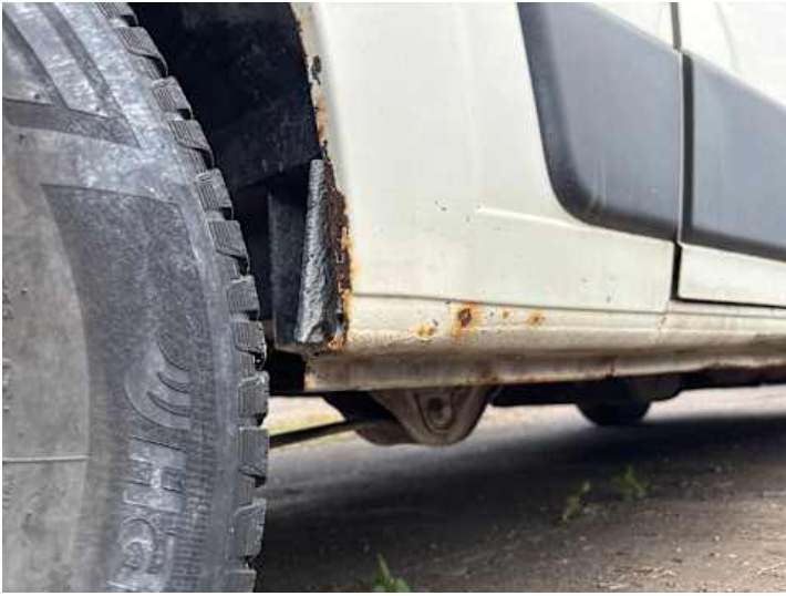
Schweller rechts (Lackschaden, Kratzer, Rost, Verformung)
