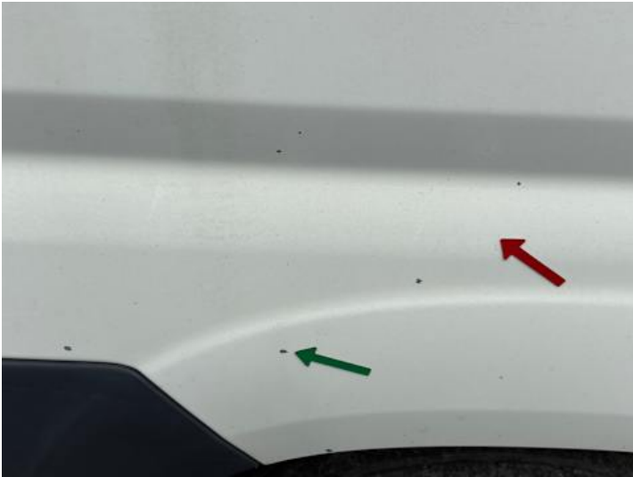
Seitenteil hinten rechts (Lackschaden)
