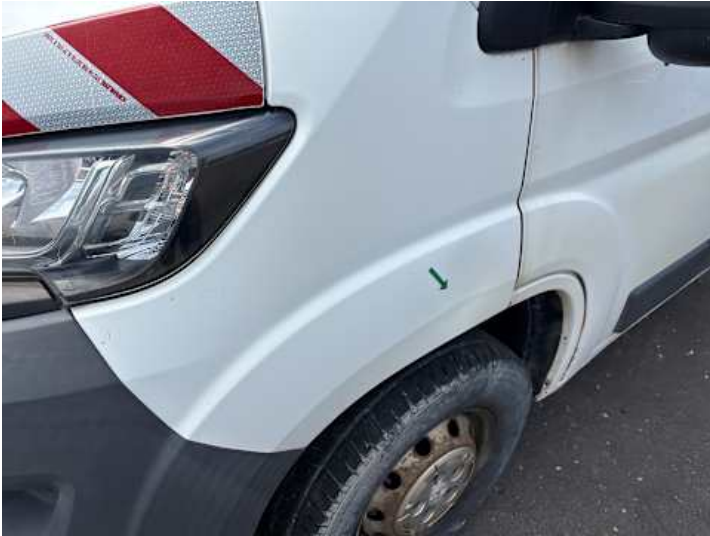
Kotflügel vorne links (Verformung)
