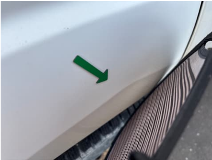
Kotflügel vorne links (Verformung)
