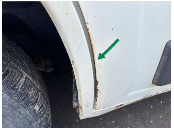
Fahrertür (Rost, Lackschaden)
