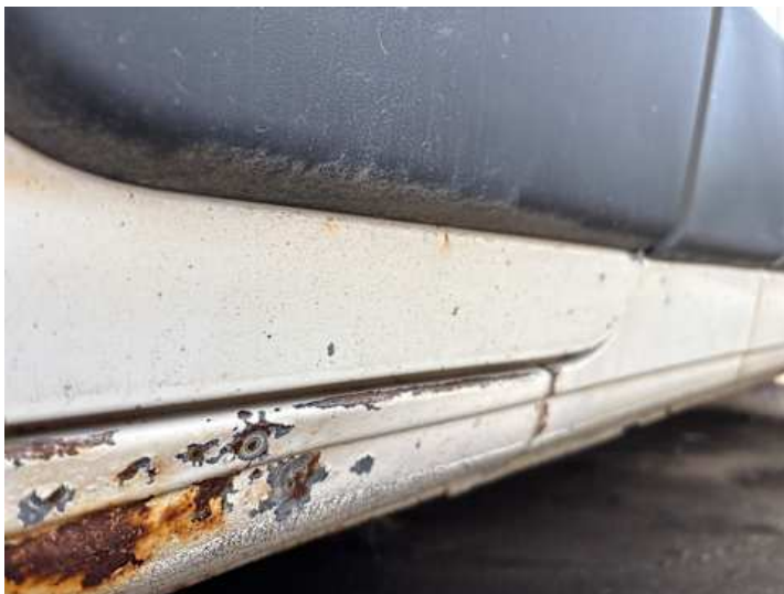
Fahrertür (Rost, Lackschaden)
