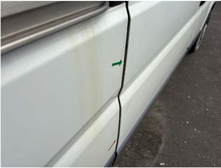
Türe hinten rechts (Spaltmaße ungenau)
