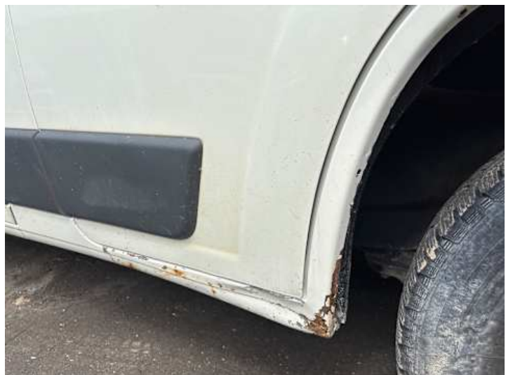
Beifahrertür (Kratzer, Lackschaden, Rost)
