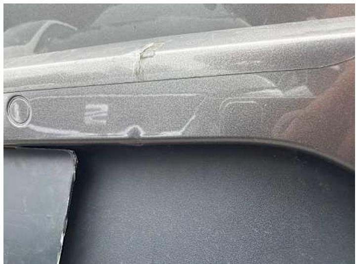
Stoßstange hinten (Kratzer, Lackschaden, Delle)
