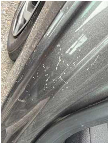
Seitenteil hinten rechts (Kratzer, Lackschaden)
