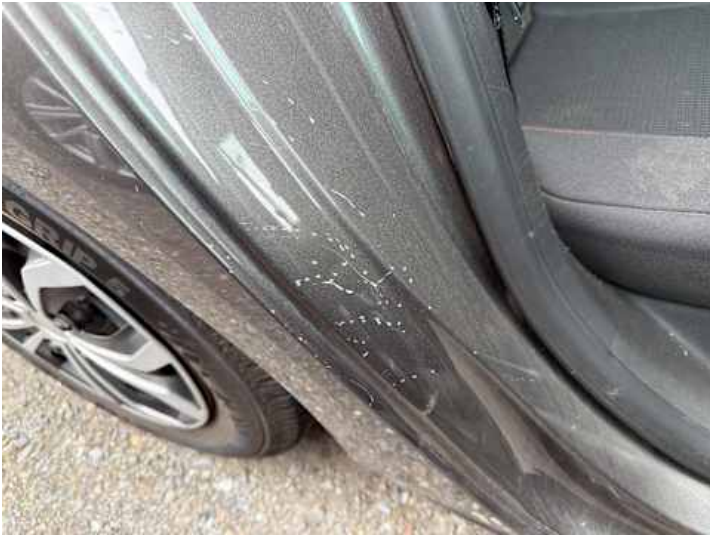
Seitenteil hinten rechts (Kratzer, Lackschaden)
