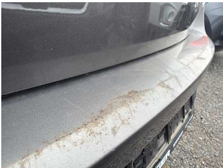
Stoßstange hinten (Kratzer, Lackschaden, Delle)
