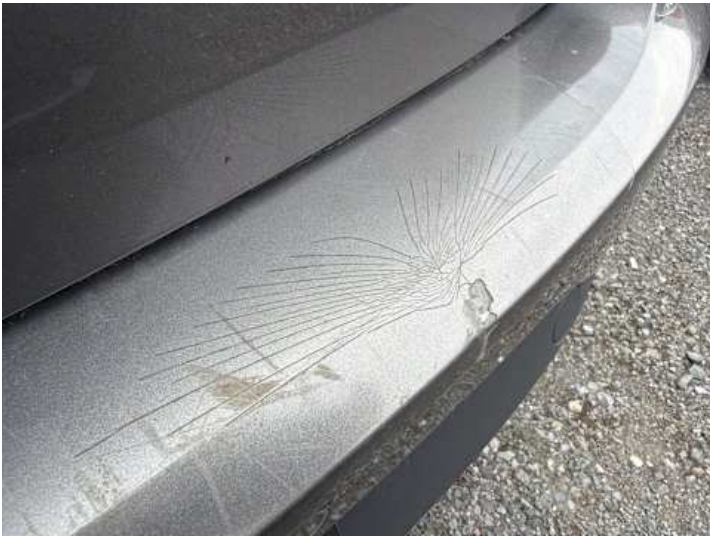
Stoßstange hinten (Kratzer, Lackschaden, Delle)
