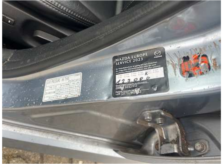
Fahrtür (Kratzer, Lackschaden, Delle, Rost)
