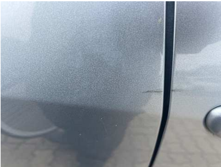
Türe hinten rechts (Kratzer, Lackschaden)
