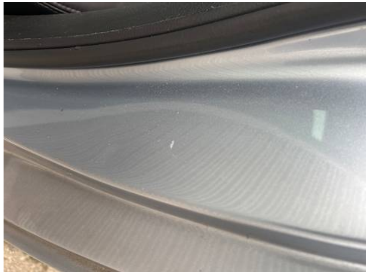
Türe hinten links (Delle)
