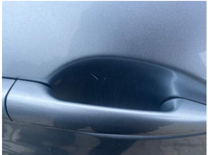
Türe hinten rechts (Kratzer, Lackschaden)
