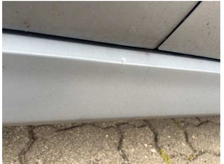
Schweller rechts (Kratzer, Lackschaden)
