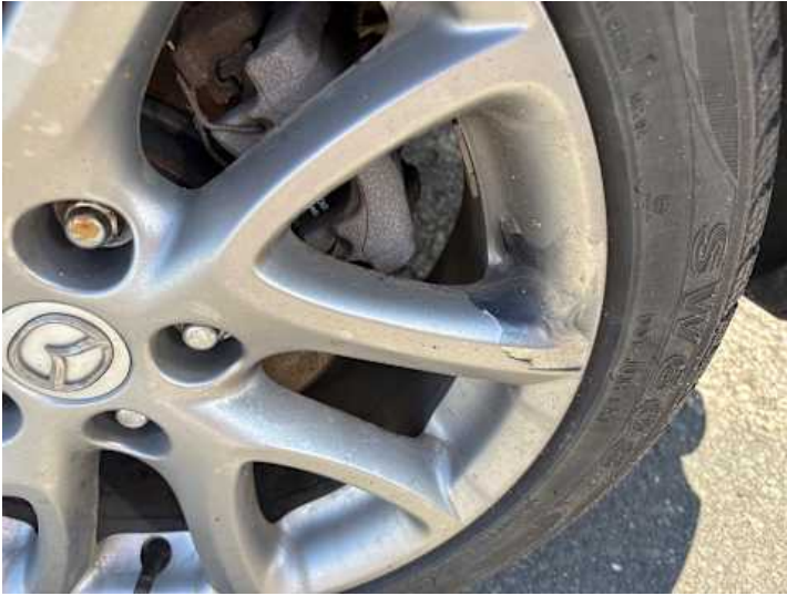
Rad (Anderer Schaden): Lackschaden
