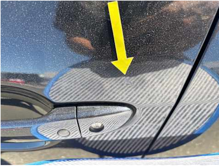
Fahrtür (Kratzer, Delle)
