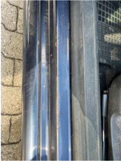
Schweller links (Kratzer, Rost)
