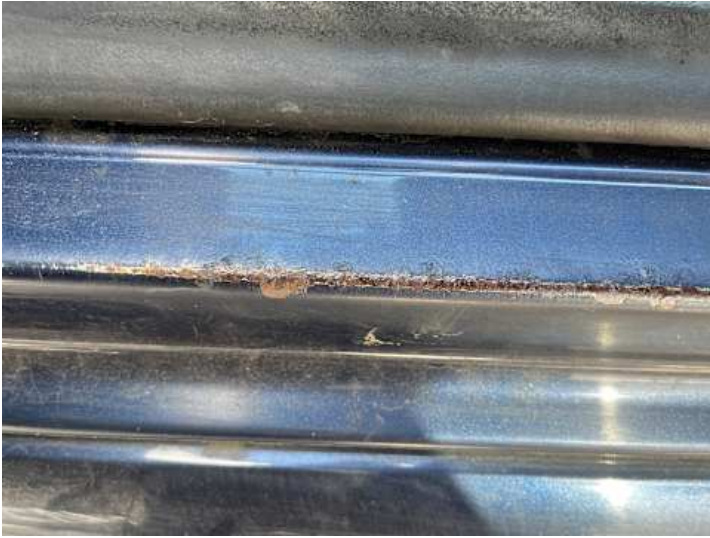
Schweller links (Kratzer, Rost)
