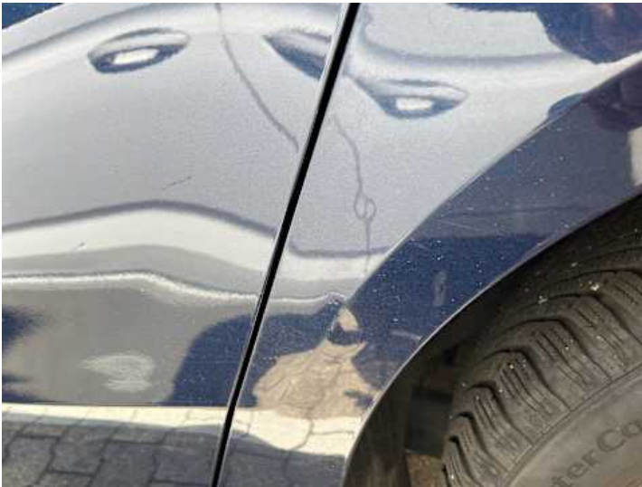
Seitenteil hinten links (Kratzer, Delle)
