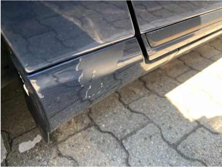
Schweller rechts (Lackschaden)
