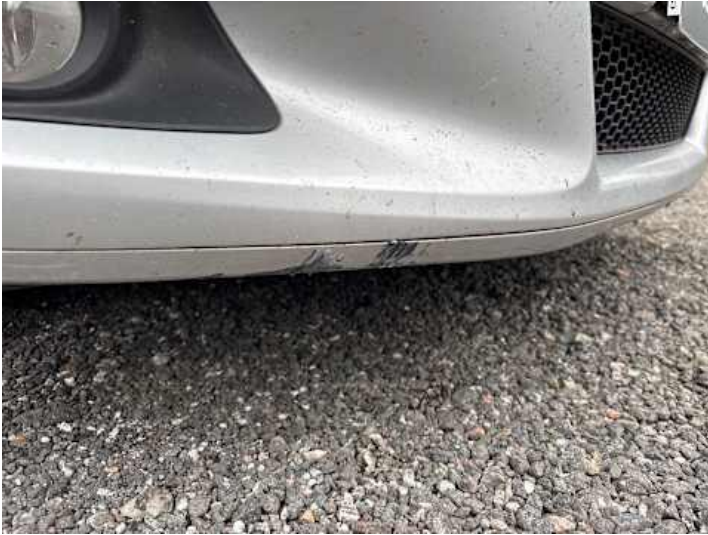
Stoßstange vorne (Lackschaden, Kratzer)
