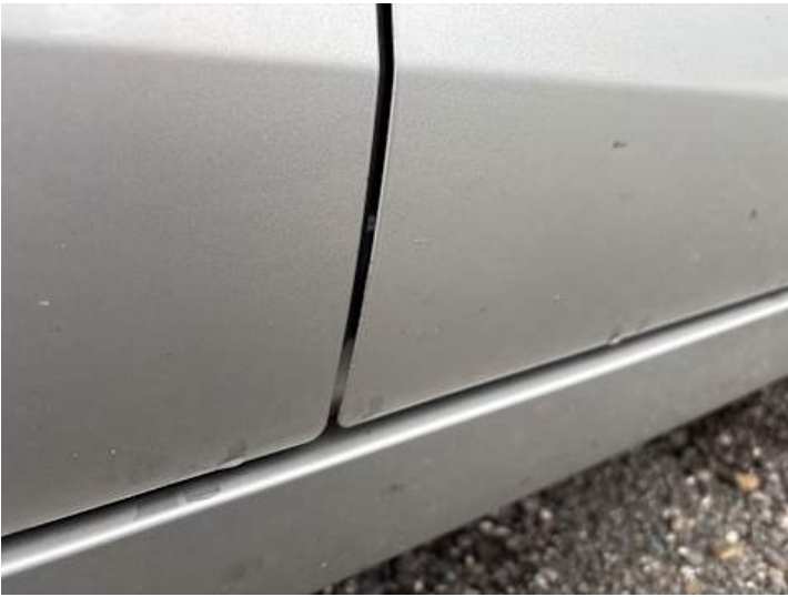
Beifahrertür (Lackschaden, Kratzer)
