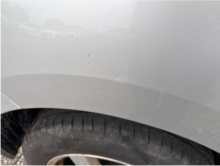
Seitenteil hinten rechts (Lackschaden, Delle, Kratzer)
