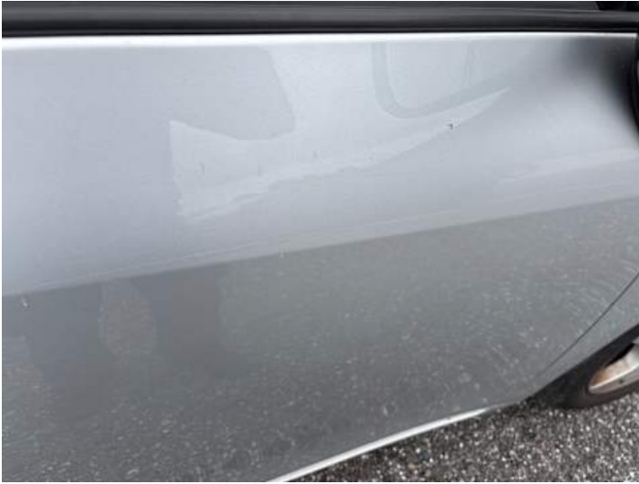
Beifahrertür (Lackschaden, Kratzer)
