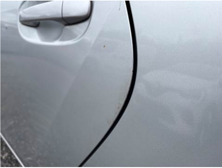
Türe hinten links (Lackschaden)
