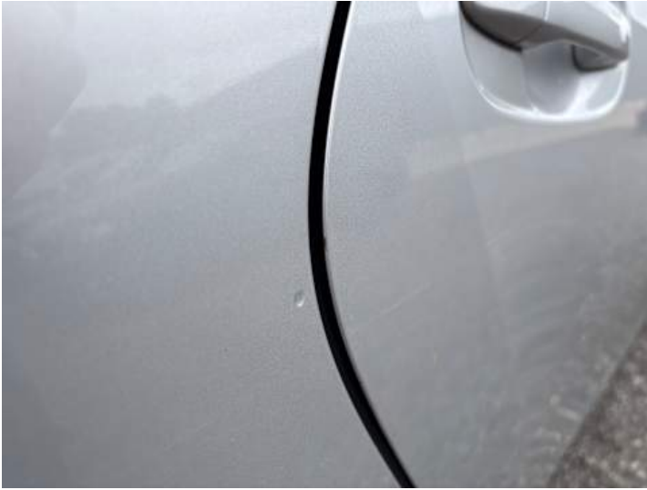
Türe hinten rechts (Kratzer, Lackschaden, Verformung)
