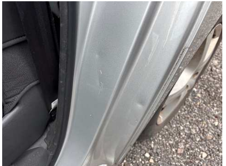
Seitenteil hinten links (Lackschaden, Delle)
