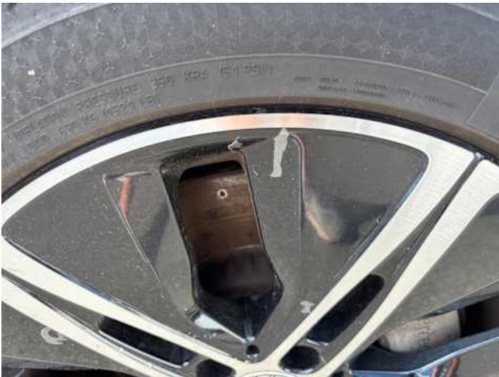
Rad (Anderer Schaden): Lackschaden
