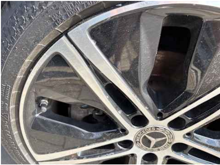
Rad (Anderer Schaden): Lackschaden
