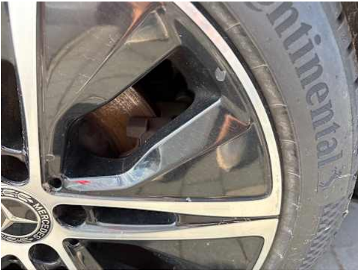
Rad (Anderer Schaden): Lackschaden
