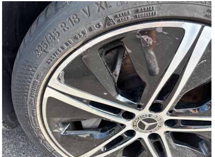
Rad (Anderer Schaden): Lackschaden
