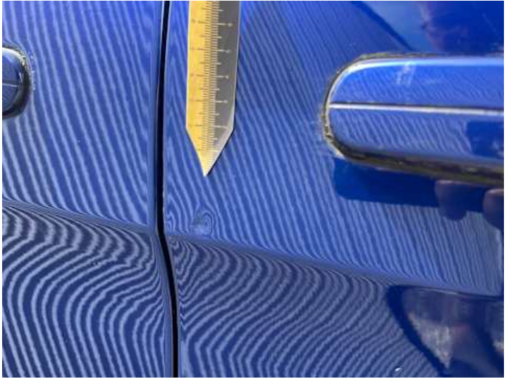
Beifahrtür (Lackschaden, Delle)
