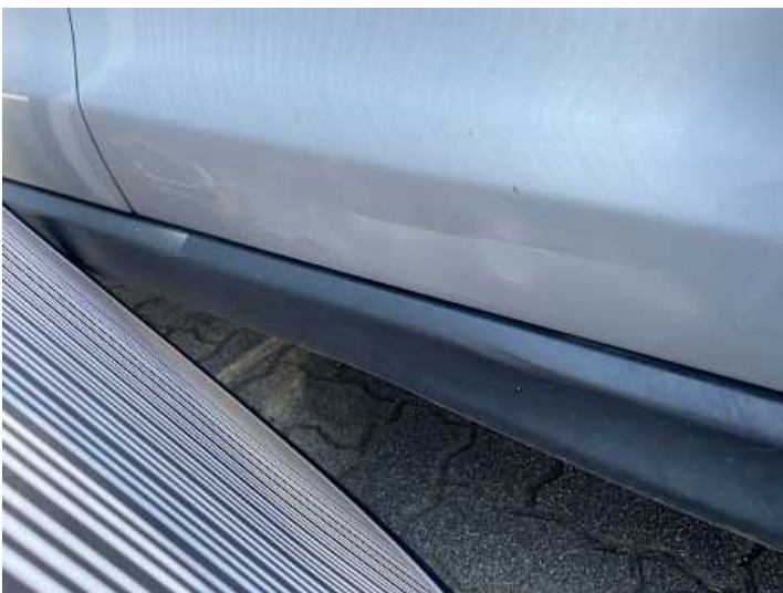
Beifahrertür (Verformung, Kratzer)
