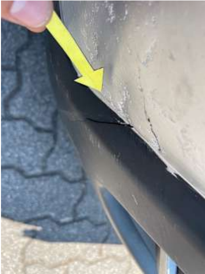
Stoßstange vorne (Unsachgemäß instand gesetzt)
