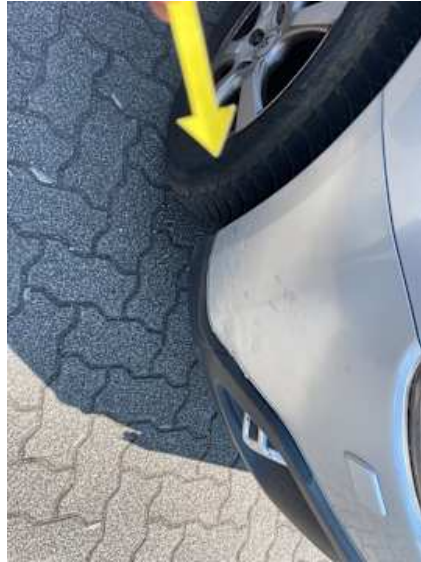
Stoßstange vorne (Unsachgemäß instand gesetzt)
