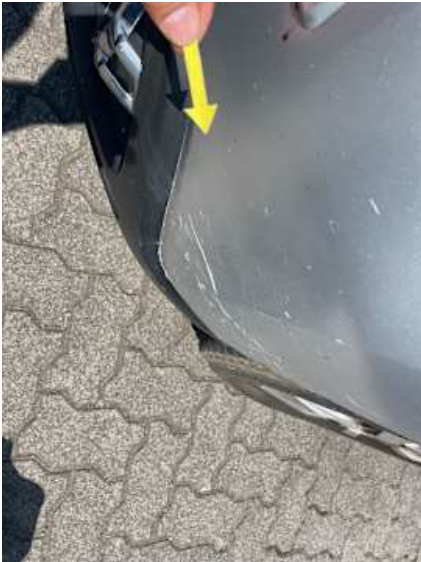
Stoßstange vorne (Unsachgemäß instand gesetzt)
