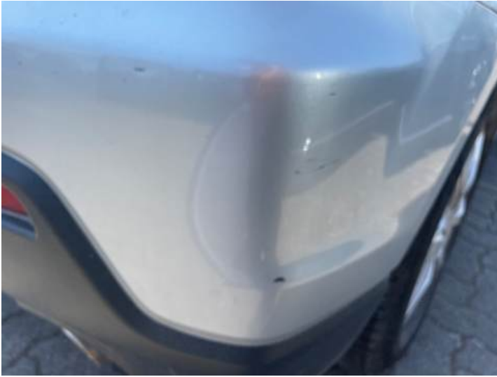
Stoßstange hinten (Kratzer)
