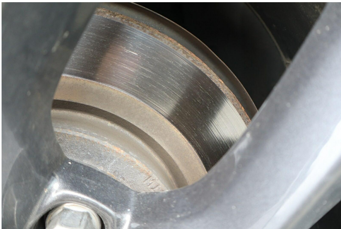
Bild 11 : Bremse vorn Tragbild mangelhaft
