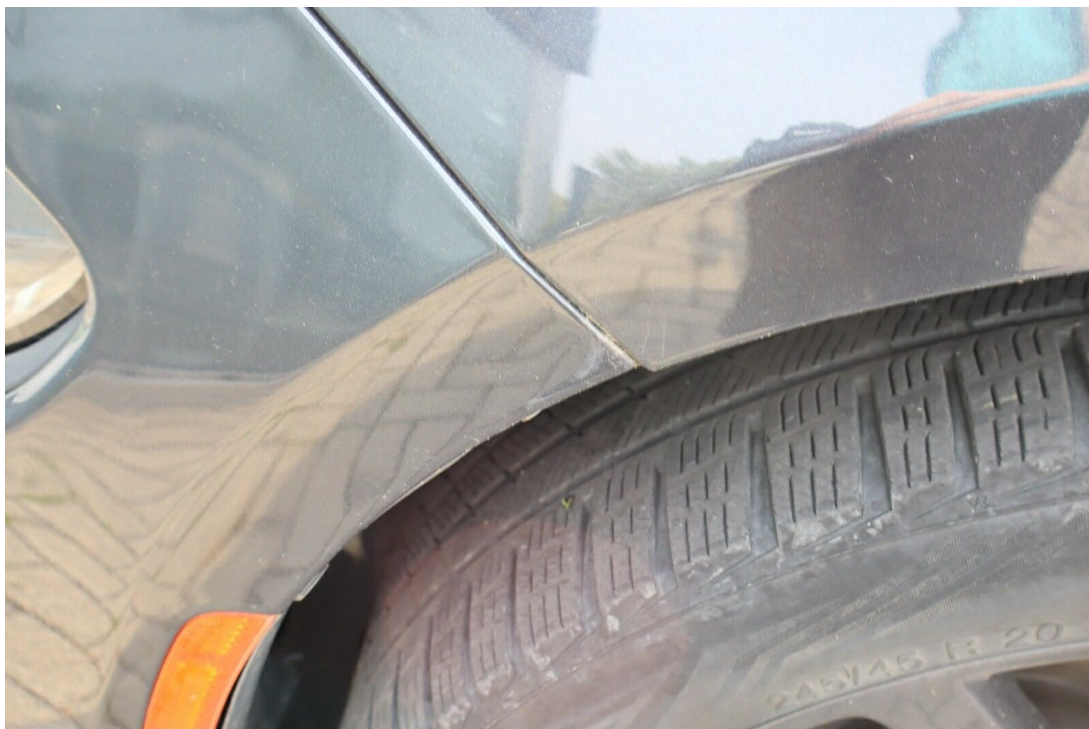
Bild 20 : Spaltmaße im Frontbereich ungleichmäßig
