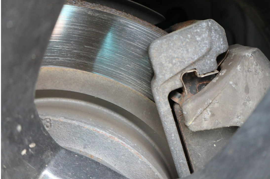
Bild 8 : Bremse vorn Tragbild mangelhaft
