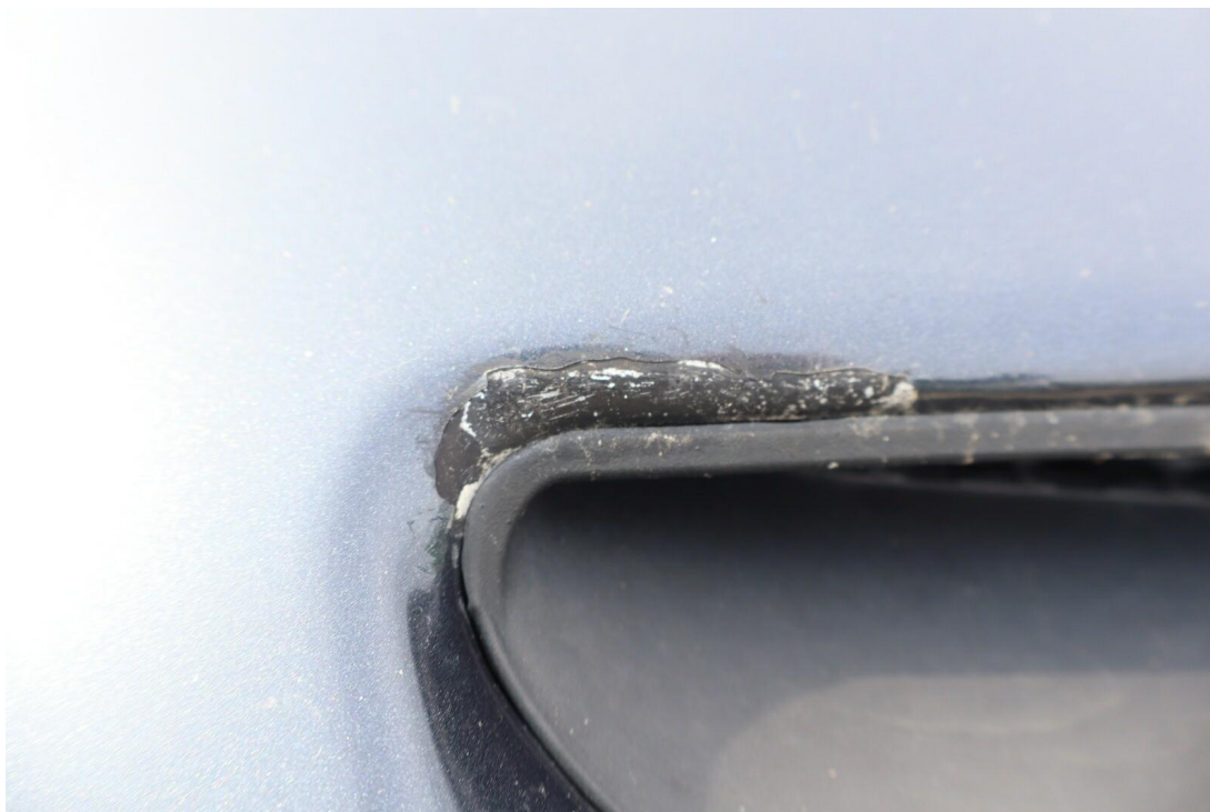
Bild 25 : Lackierung Motorhaube innen rissig, aussen abgeplatzt
