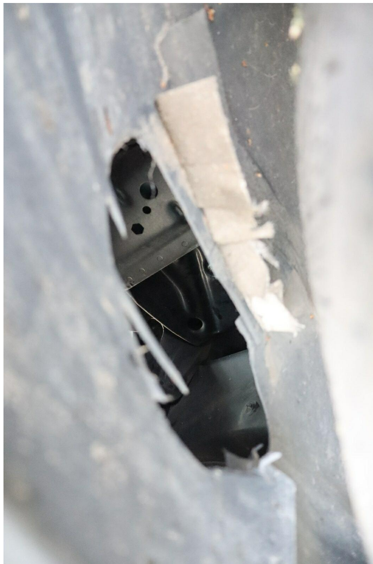
Bild 9 : Radhausinnenverkleidung vorn links Loch, rechts zugeklebt
