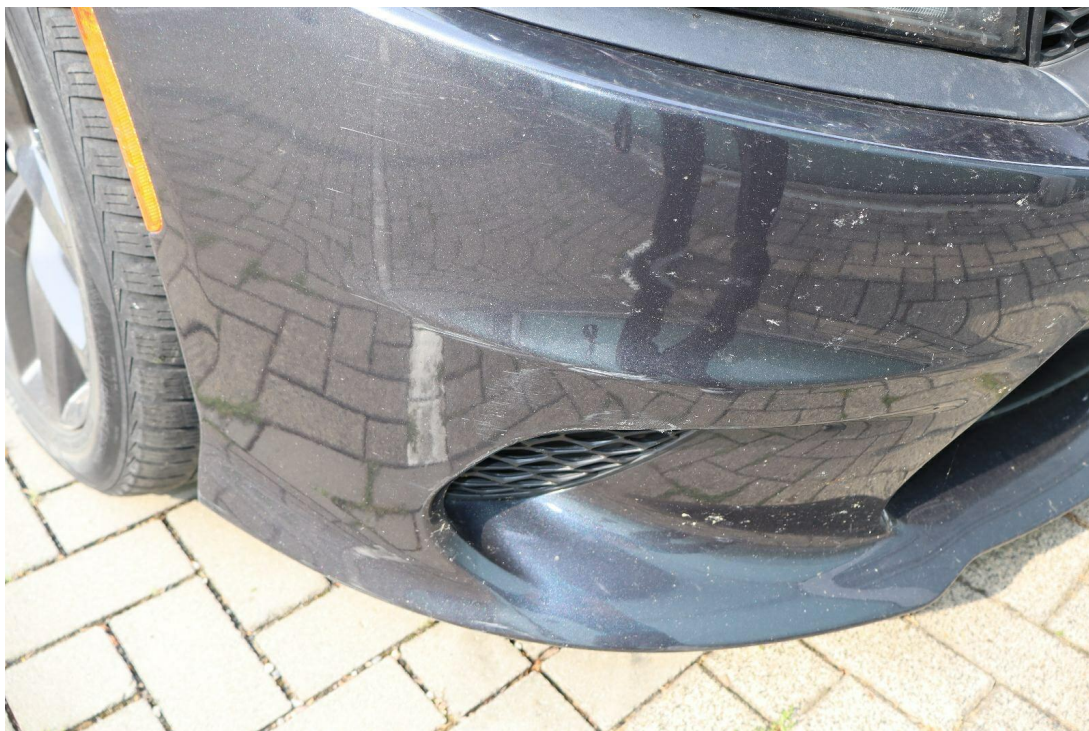
Bild 21 : Stoßfängerverkleidung vorn verformt
