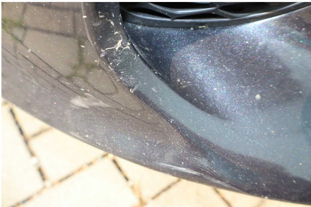
Bild 23 : Stoßfängerverkleidung vorn verformt
