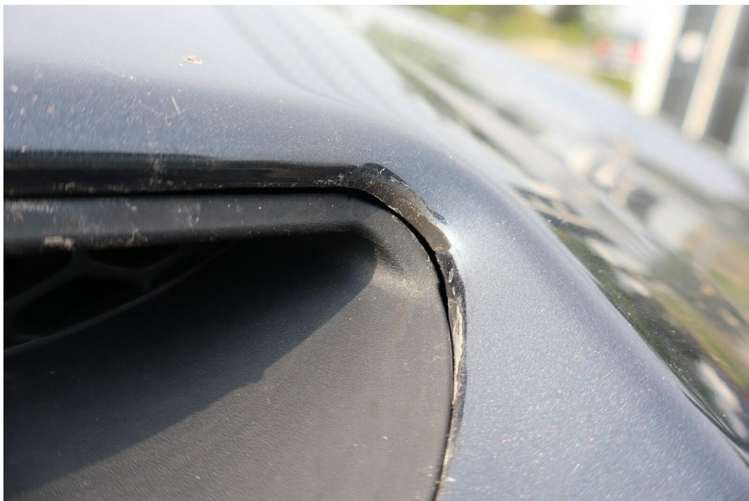
Bild 26 : Lackierung Motorhaube innen rissig, aussen abgeplatzt
