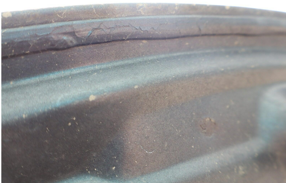
Bild 13 : Lackierung Motorhaube innen rissig, aussen abgeplatzt
