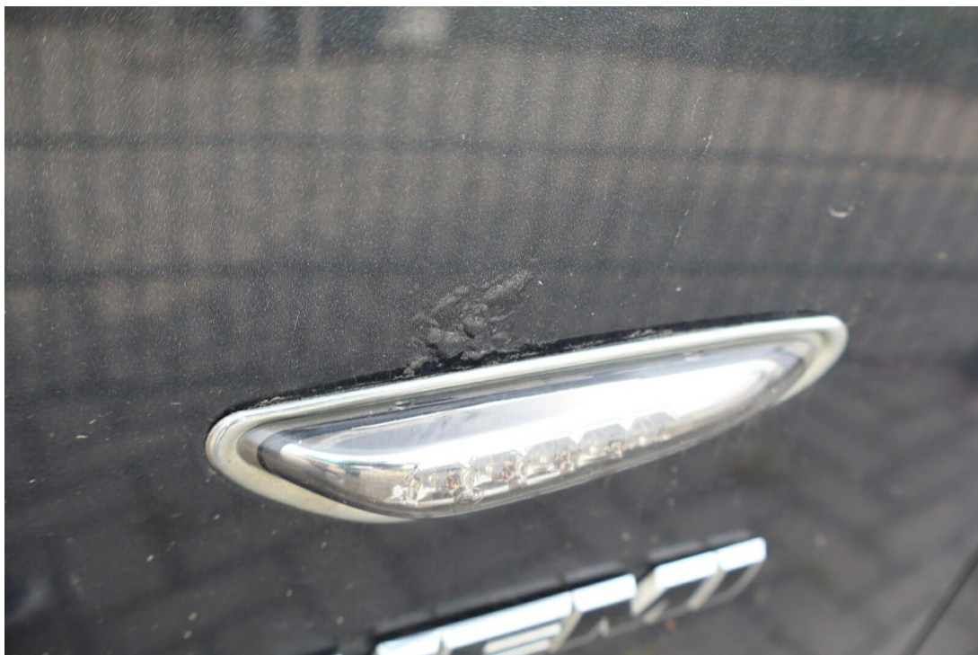
Bild 24 : Kotflügel vorn links Rostansatz
