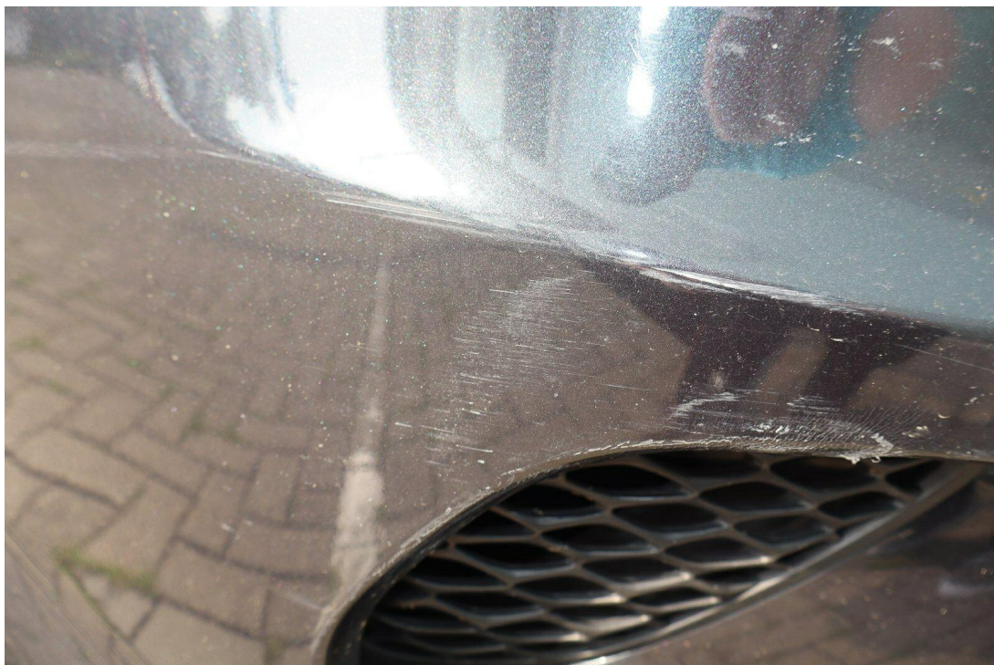
Bild 22 : Stoßfängerverkleidung vorn verformt
