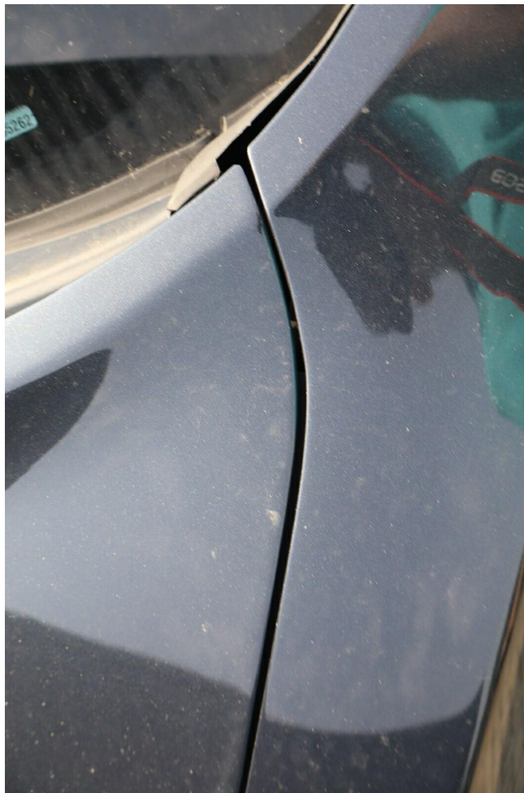
Bild 17 : Spaltmaße im Frontbereich ungleichmäßig
