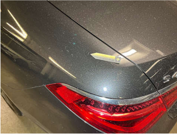
Seitenteil hinten links (Kratzer)
