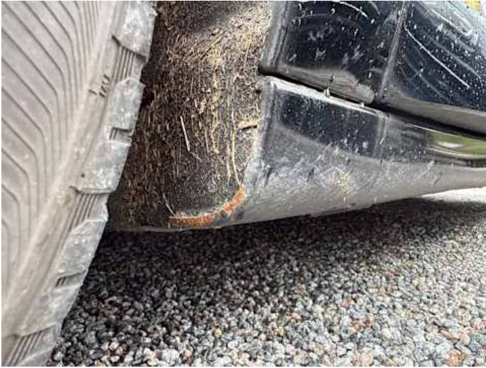
Schweller links (Rost)
