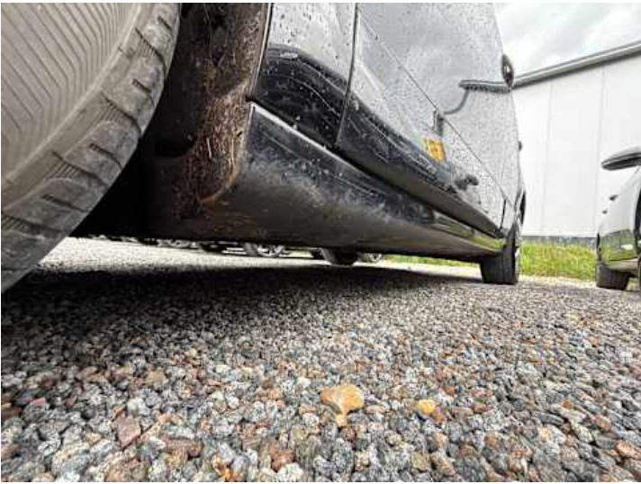
Schweller links (Rost)
