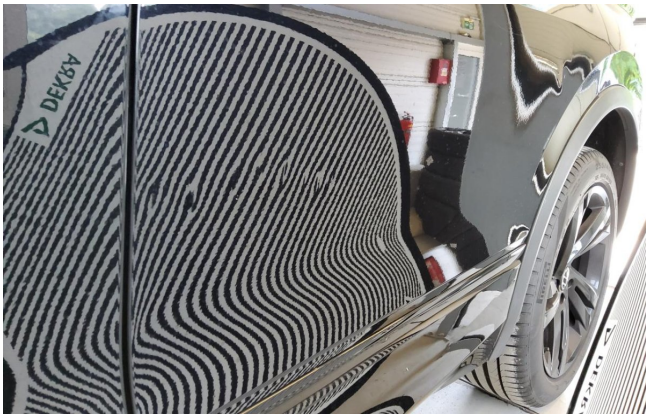
Tür hinten links - Instands. und lackieren
