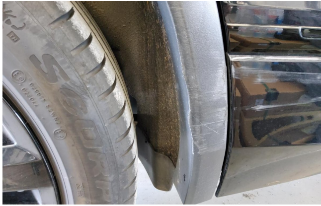
Radlaufblende hinten rechts verschrammt ersetzen
