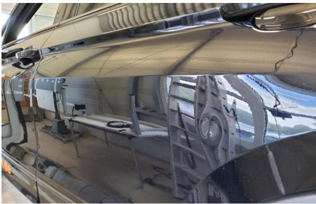
Tür hinten links - Instands. und lackieren
