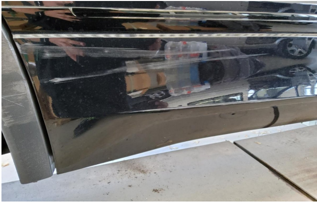
Türblende hinten rechts Kratzer Lackieren
