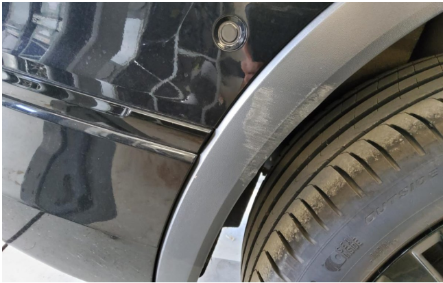
Radlaufblende hinten rechts verschrammt ersetzen
