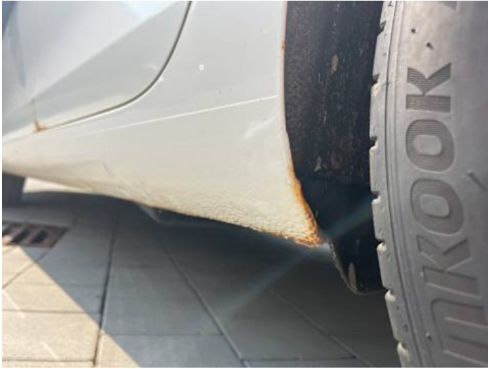
Schweller links (Rost)
