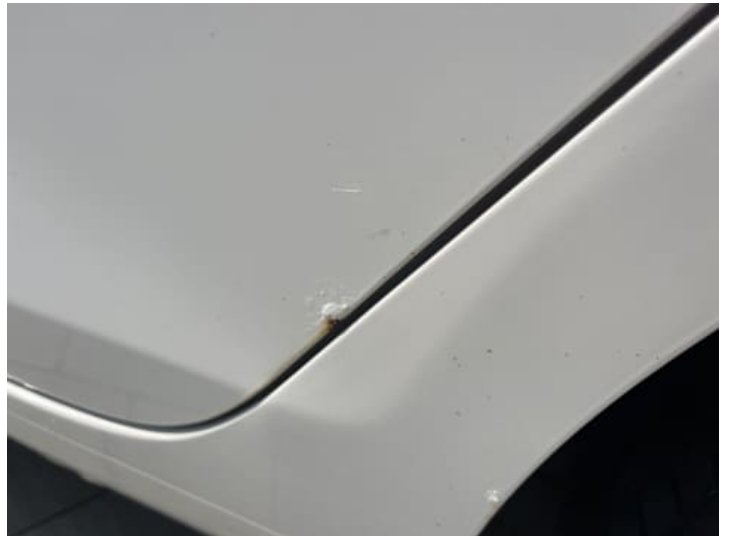
Türe hinten links (Rost)
