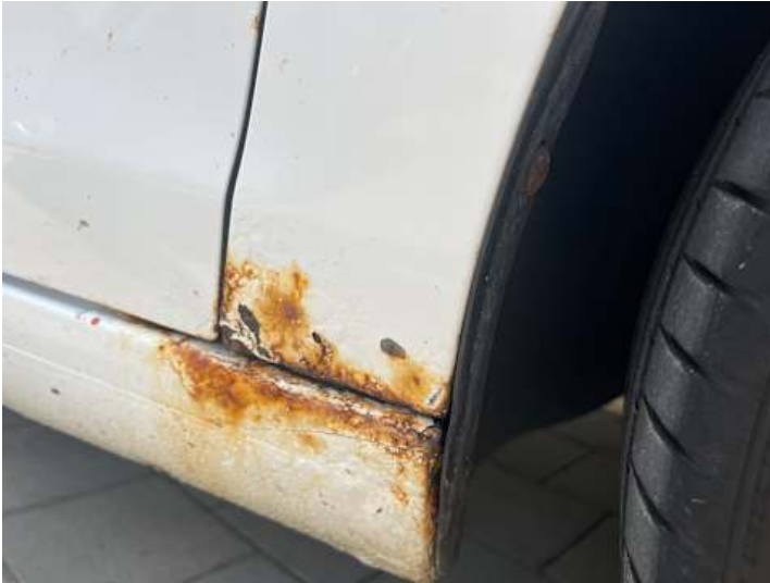
Kotflügel vorne rechts (Rost)
