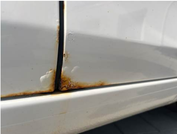
Türe hinten links (Rost)
