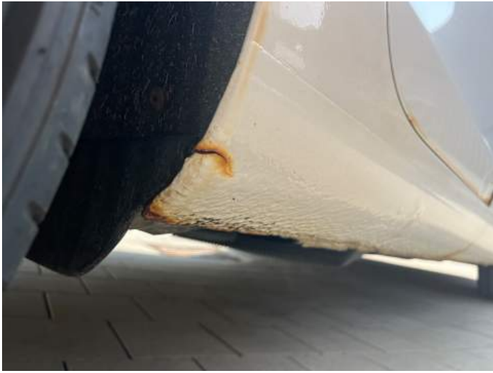
Schweller rechts (Rost)
