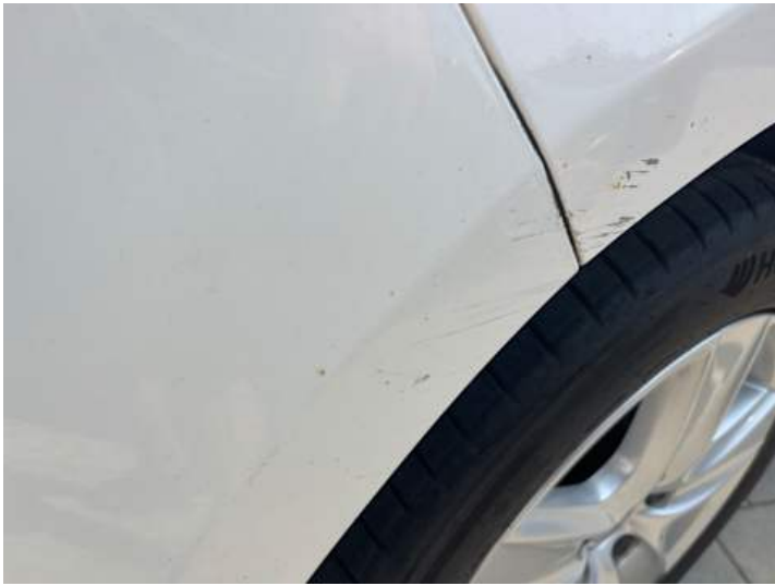
Stoßstange hinten (Lackschaden, Kratzer)
