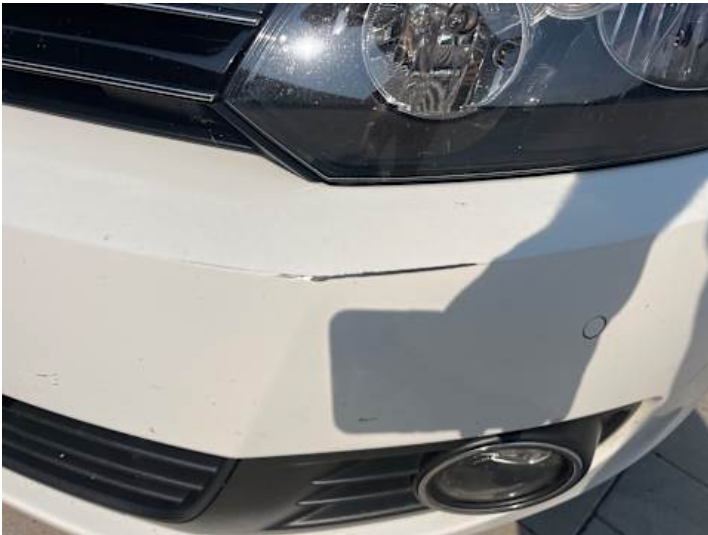
Stoßstange vorne (Lackschaden, Kratzer)
