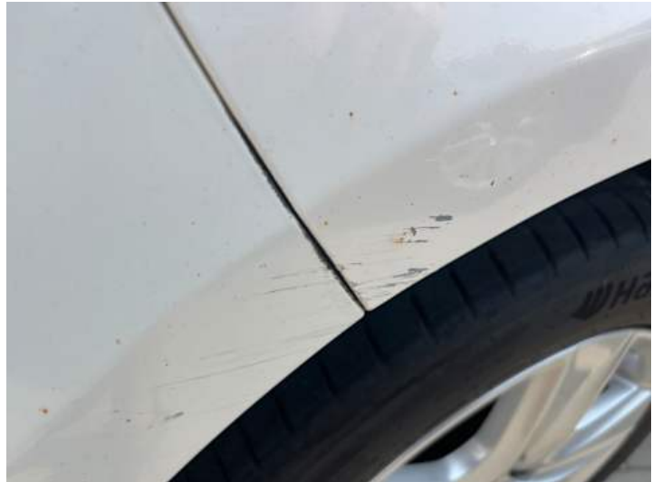
Seitenteil hinten rechts (Lackschaden, Kratzer)
