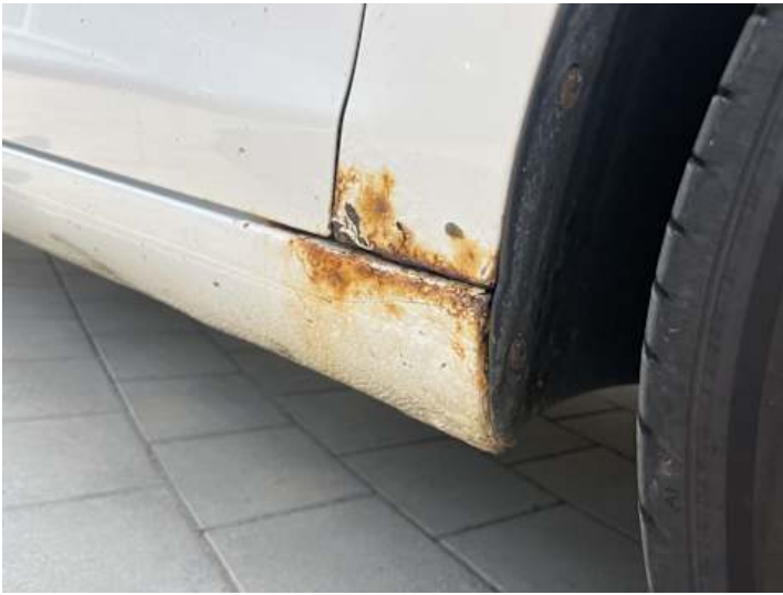
Schweller rechts (Rost)
