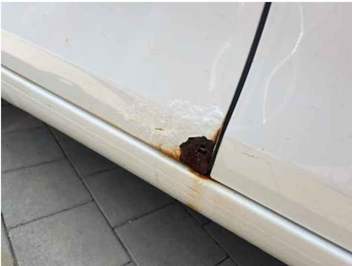
Türe hinten rechts (Rost)
