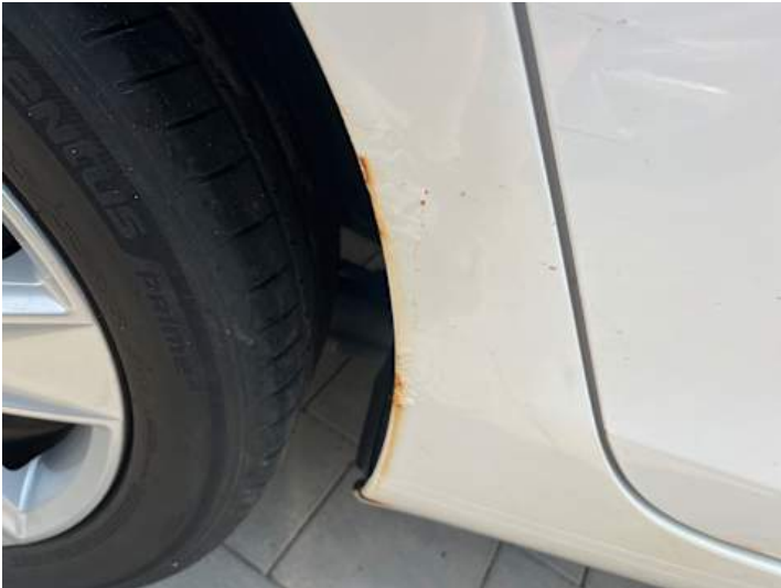
Seitenteil hinten rechts (Rost)
