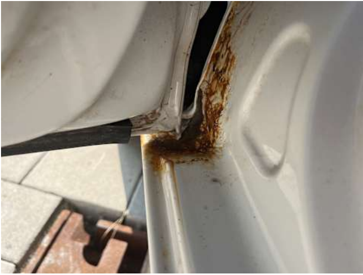
Schweller links (Rost)
