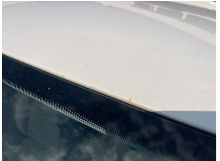
Dach (Lackschaden, Rost)
