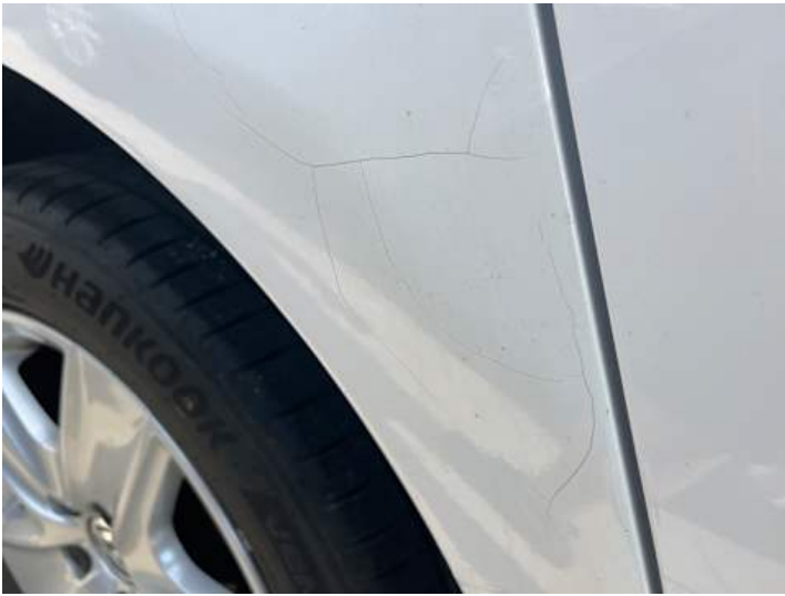
Seitenteil hinten rechts (Unsachgemäß instand gesetzt, Lackschaden)
