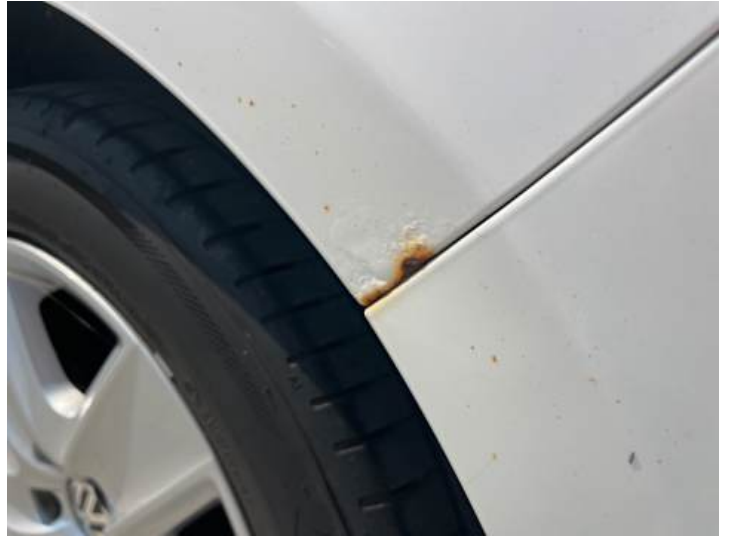
Seitenteil hinten links (Rost)
