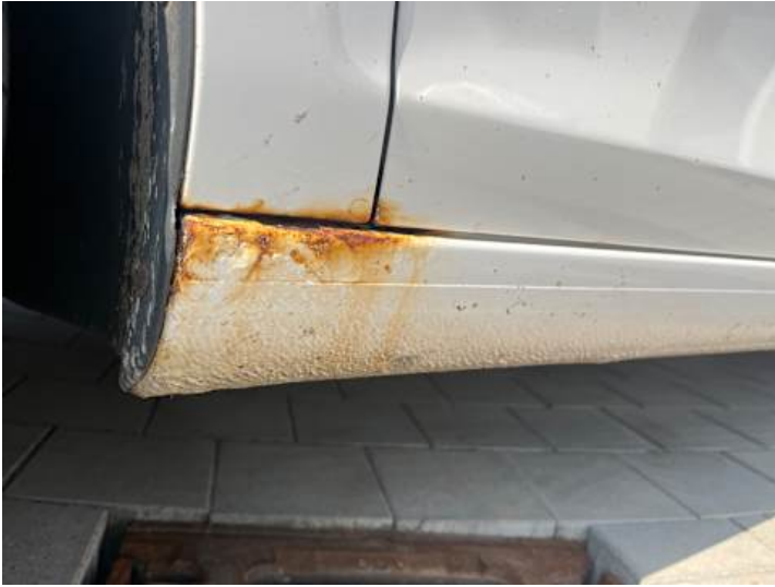
Schweller links (Rost)
