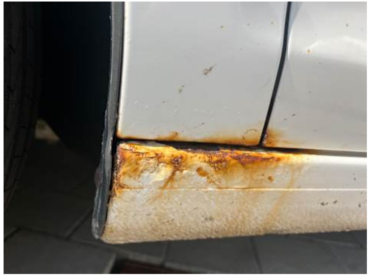
Kotflügel vorne links (Rost)
