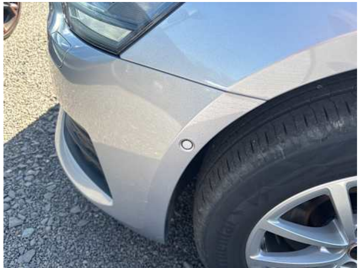
Stoßstange vorne (Unsachgemäß instand gesetzt)
