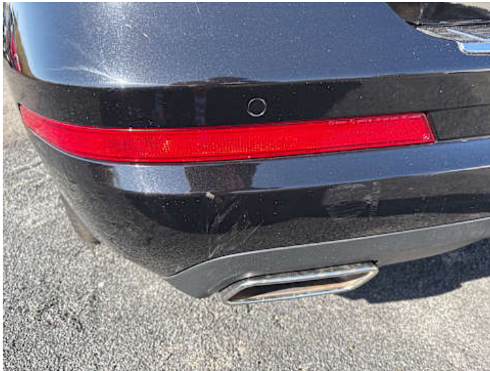
Stoßstange hinten (Kratzer)
