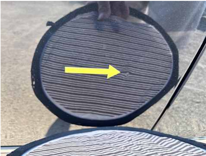
Fahrrertür (Delle, Kratzer)
