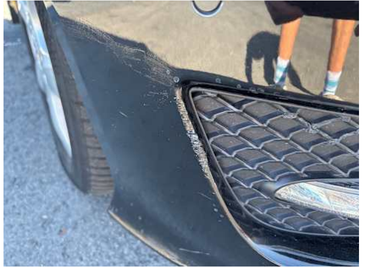
Stoßstange vorne (Unsachgemäß instand gesetzt, Kratzer)
