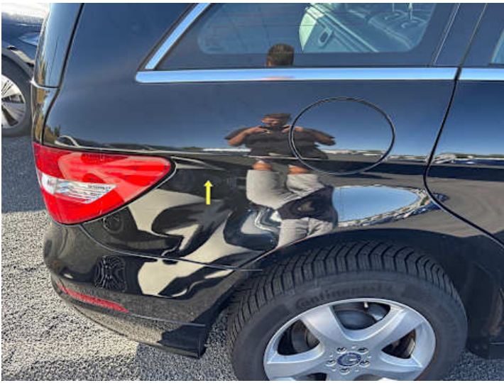
Seitenteil hinten rechts (Kratzer)
