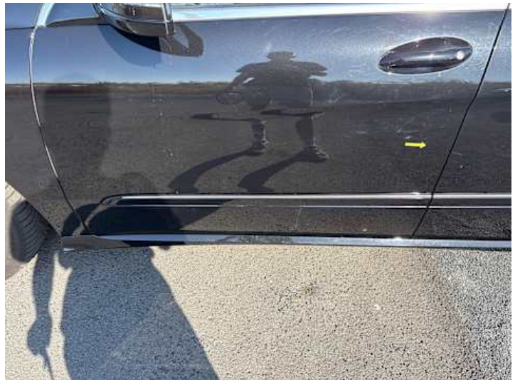
Fahrtür (Delle, Kratzer)
