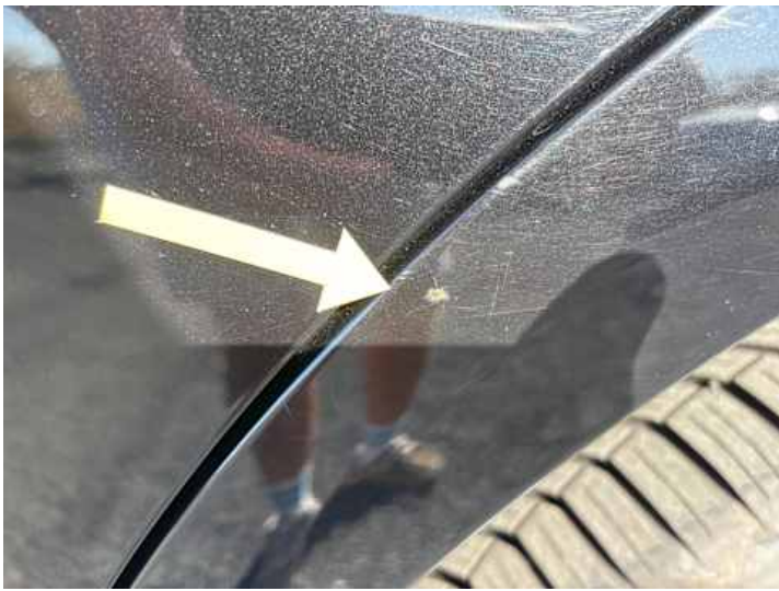
Seitenteil hinten links (Rost)
