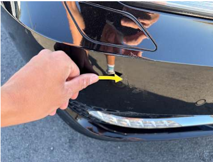
Stoßstange vorne (Unsachgemäß instand gesetzt, Kratzer)
