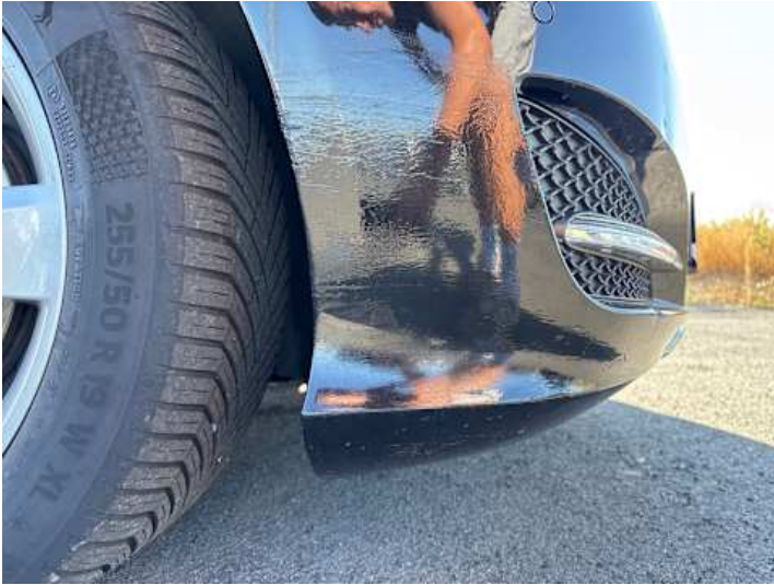
Stoßstange vorne (Unsachgemäß instand gesetzt, Kratzer)
