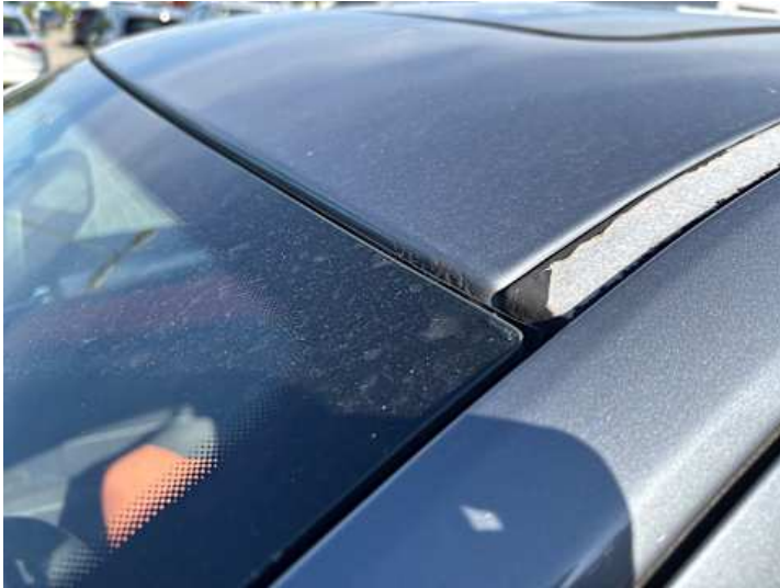
Dach (Lackschaden, Anderer Schaden, Rost): Kappe fehlt
