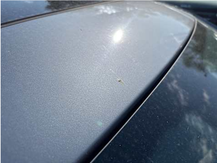
Dach (Lackschaden, Anderer Schaden, Rost): Kappe fehlt
