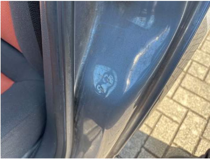
Seitenteil hinten links (Lackschaden, Delle)
