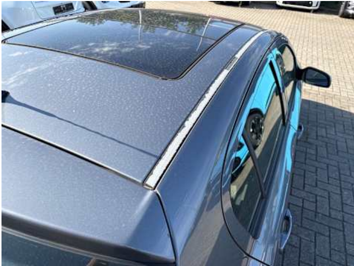
Dach (Lackschaden, Anderer Schaden, Rost): Kappe fehlt
