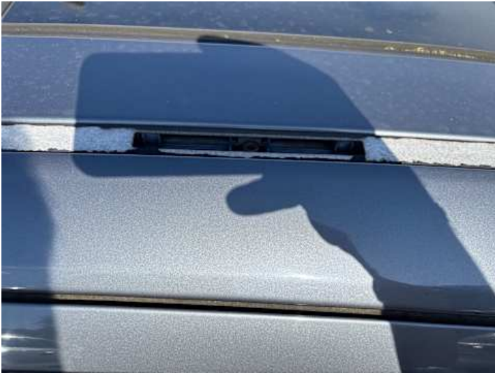
Dach (Lackschaden, Anderer Schaden, Rost): Kappe fehlt
