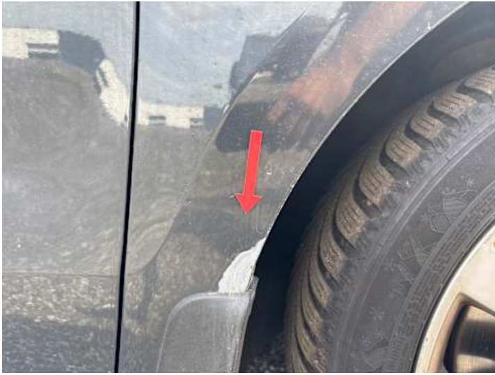
Kotflügel vorne rechts (Unsachgemäß instand gesetzt, Lackschaden)
