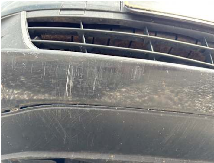
Stoßstange vorne (Lackschaden, Kratzer)
