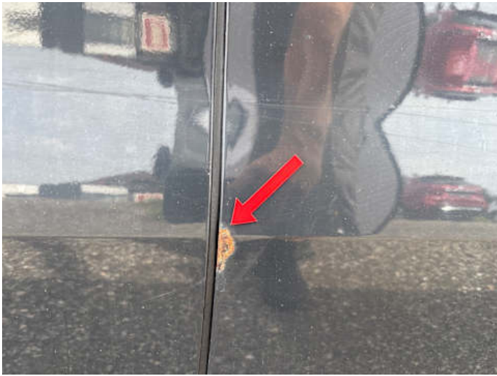
Beifahrertür (Lackschaden, Rost)
