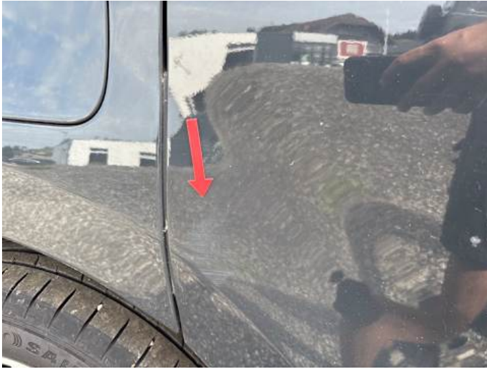
Türe hinten rechts (Lackschaden, Kratzer)
