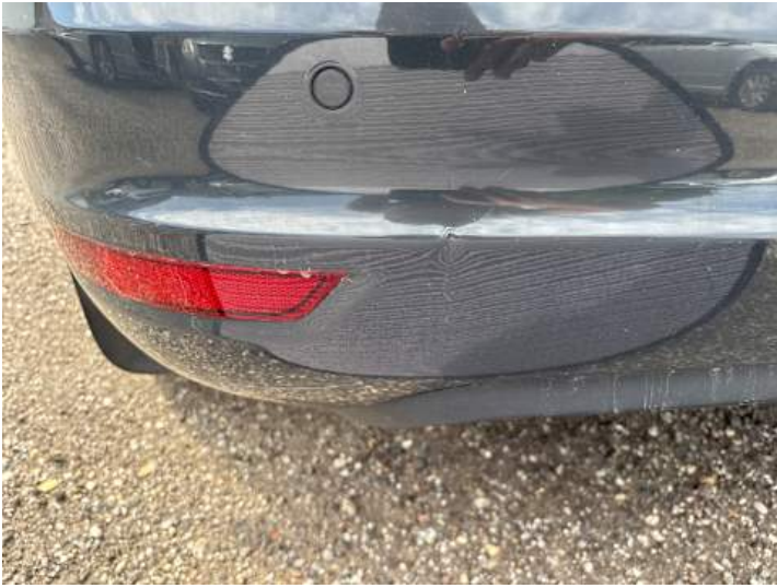
Stoßstange hinten (Lackschaden, Verformung)
