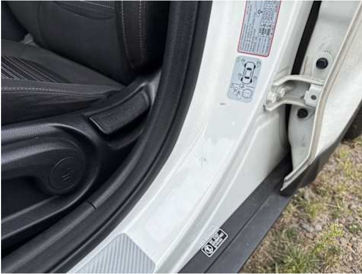
Schweller links (Kratzer, Delle)
