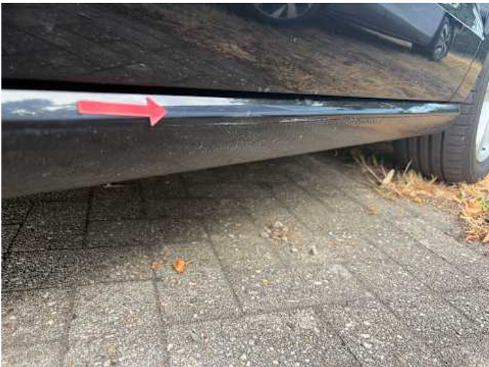
Schweller rechts (Kratzer)
