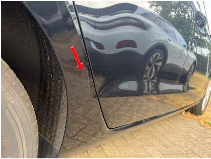
Seitenteil hinten rechts (Kratzer)
