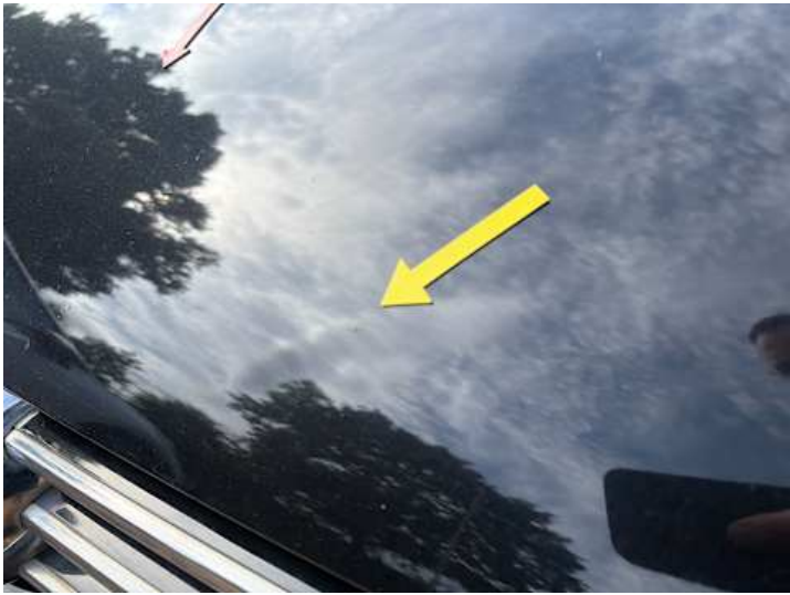
Motorhaube (Rost, Steinschlag)
