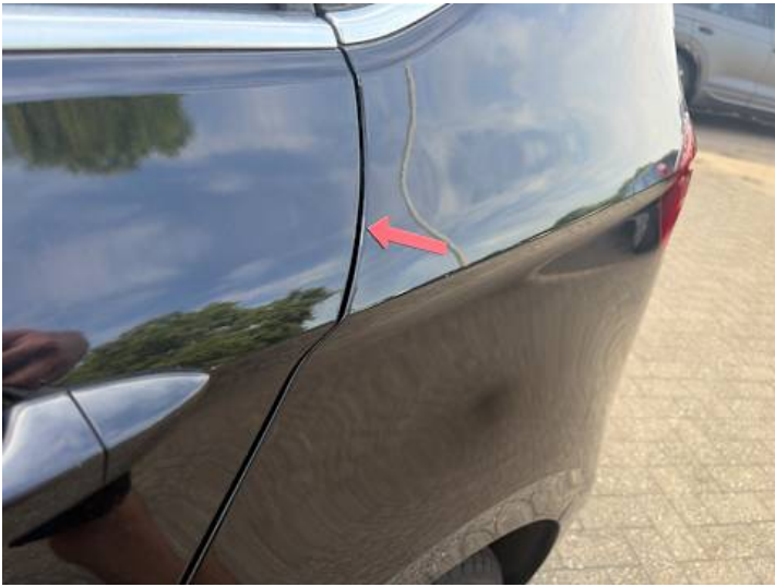
Seitenteil hinten links (Lackschaden)
