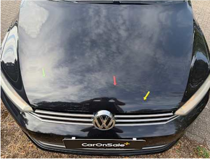
Motorhaube (Steinschlag, Rost, Delle)
