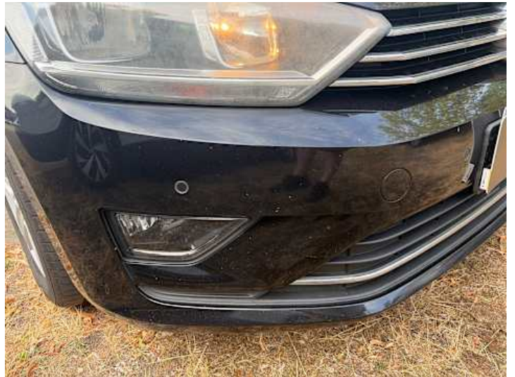
Stoßstange vorne (Steinschlag)
