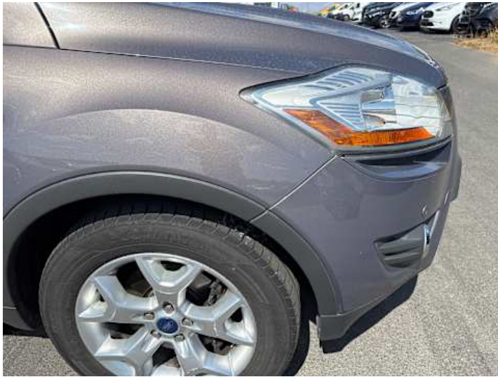
Stoßstange vorne (Unsachgemäß instand gesetzt)
