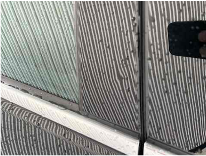
Türe hinten rechts (Delle)
