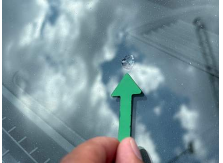
Windschutzscheibe (Steinschlag, Riss/Bruch)
