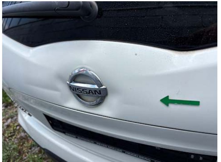
Heckklappe (Unsachgemäß instand gesetzt)
