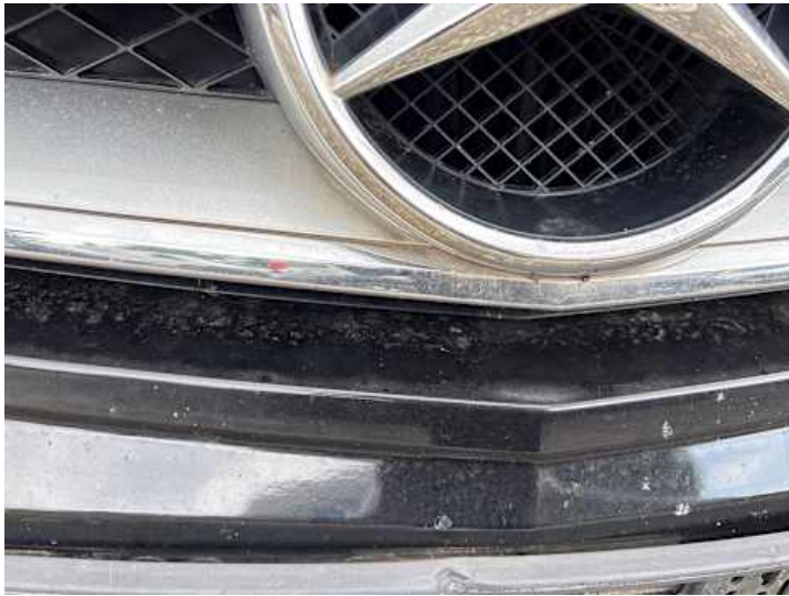
Stoßstange vorne (Kratzer, Spaltmaße ungenau)
