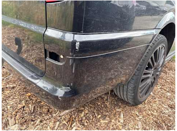
Stoßstange hinten (Kratzer, Anderer Schaden): Reflektor fehlt
