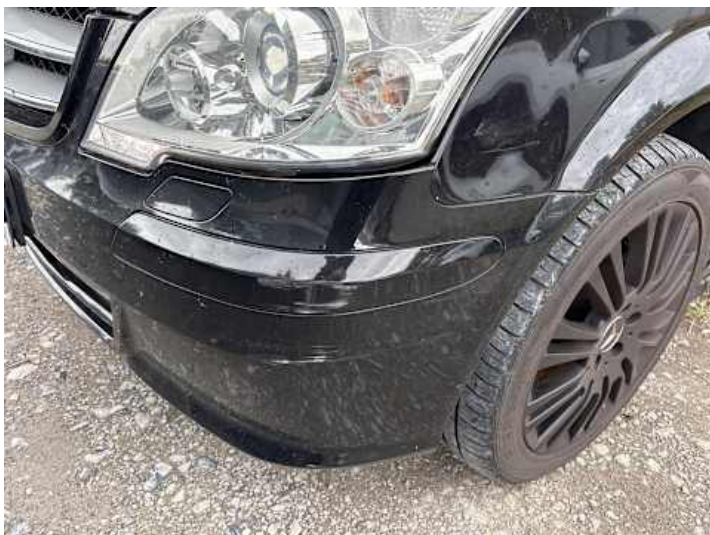
Stoßstange vorne (Kratzer, Spaltmaße ungenau)
