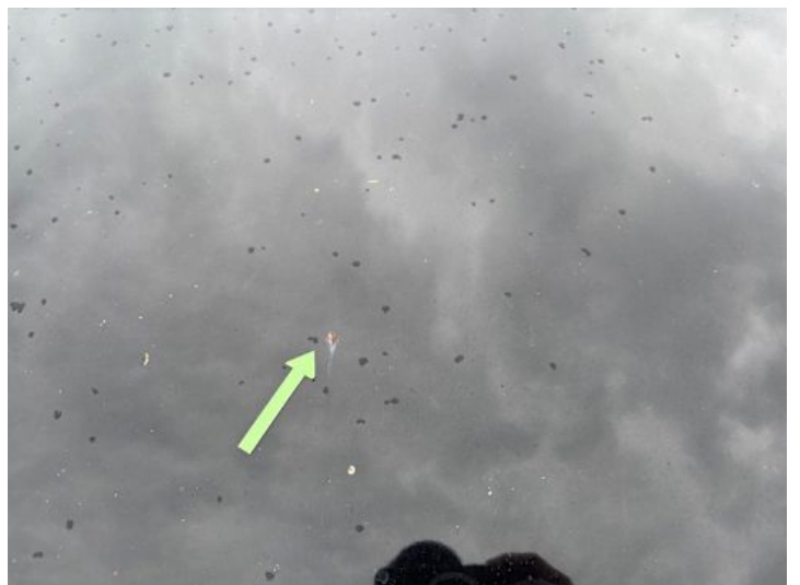
Motorhaube (Steinschlag, Rost)
