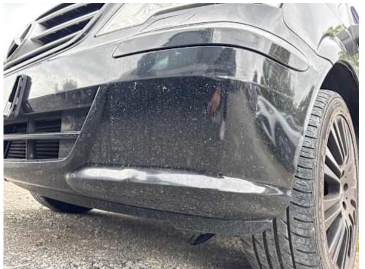
Stoßstange vorne (Kratzer, Spaltmaße ungenau)
