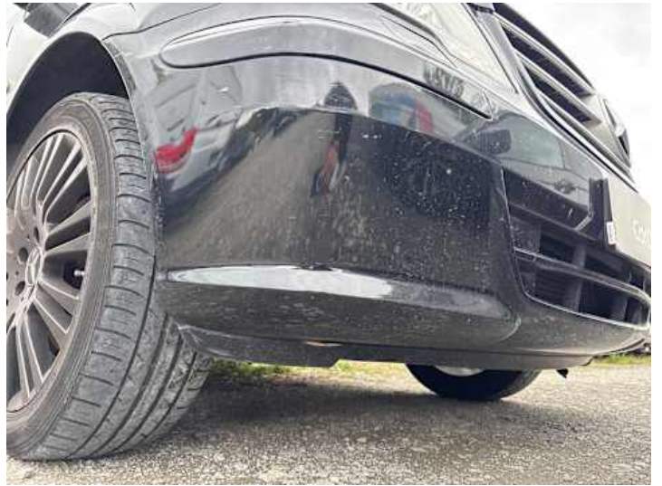
Stoßstange vorne (Kratzer, Spaltmaße ungenau)
