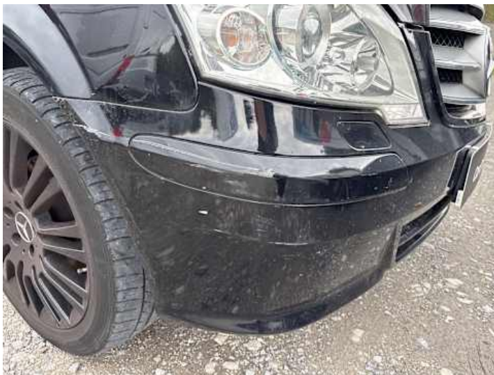
Stoßstange vorne (Kratzer, Spaltmaße ungenau)
