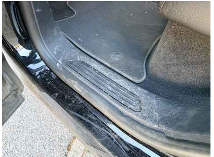
Innenraum (Verschmutzung, Verschleiß, Kratzer)
