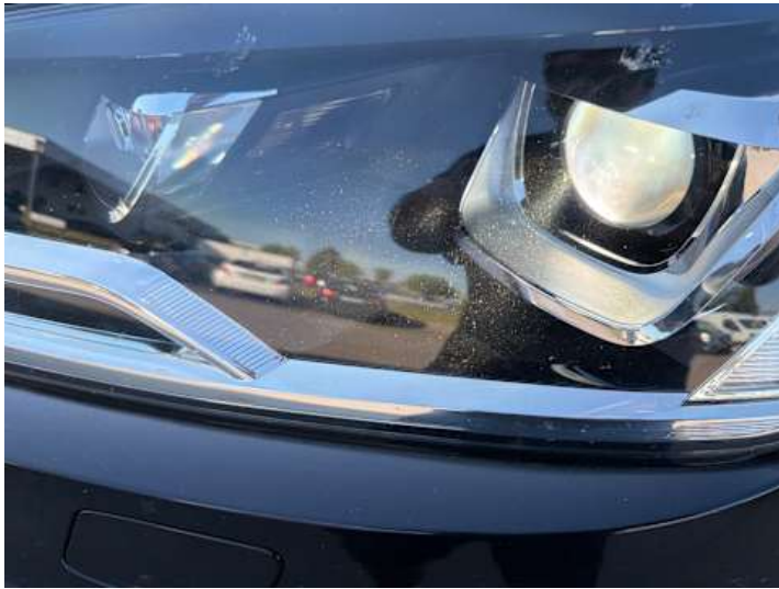
Scheinwerfer (links) (Kratzer, Steinschlag)
