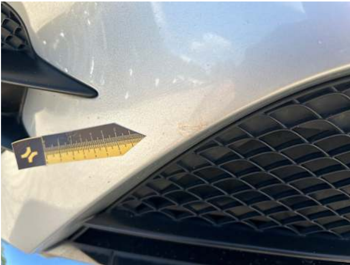
Stoßstange vorne (Kratzer)
