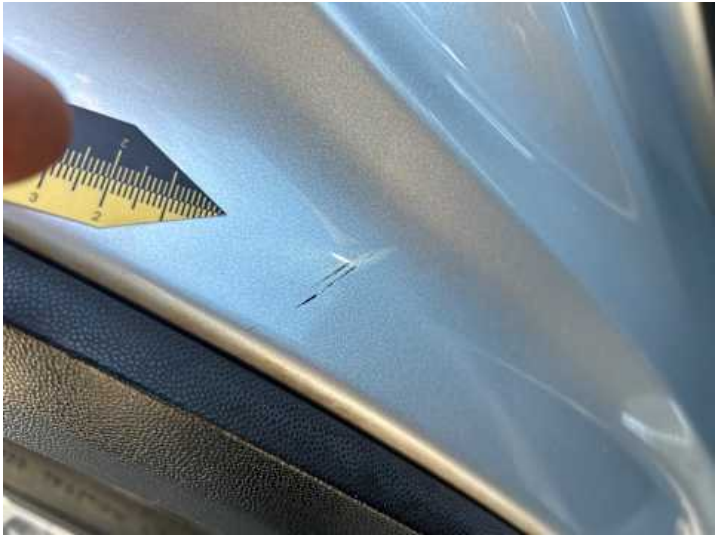
Schweller rechts (Kratzer)
