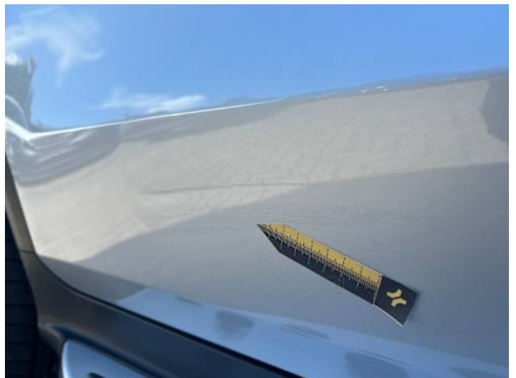
Türe hinten rechts (Verformung)
