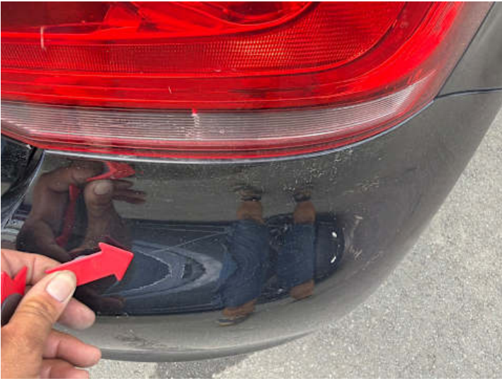
Stoßstange hinten (Kratzer, Unsachgemäß instand gesetzt)
