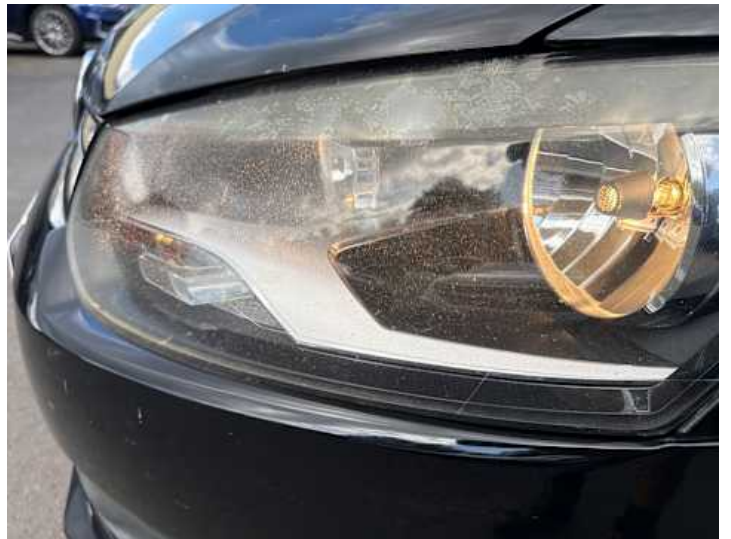
Scheinwerfer (links) (Steinschlag, Kratzer)
