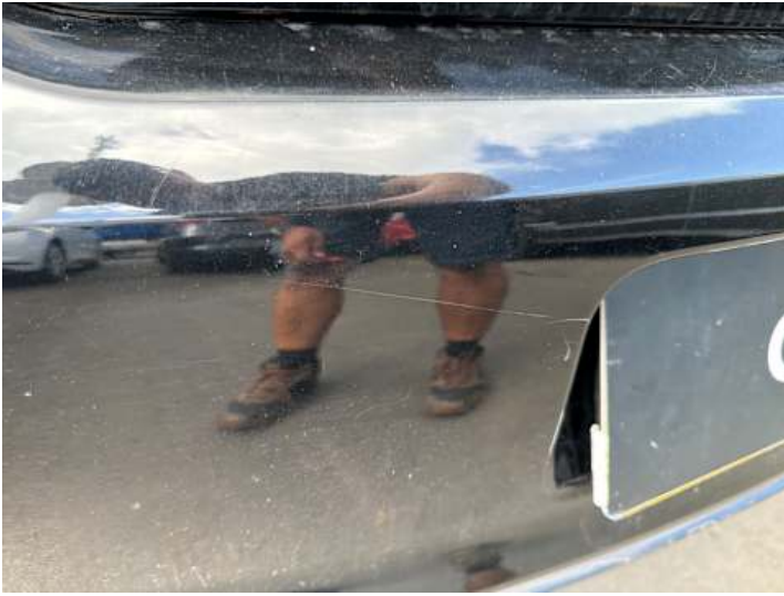
Stoßstange hinten (Kratzer, Unsachgemäß instand gesetzt)
