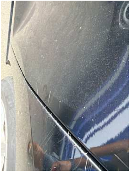
Türe hinten links (Kratzer)
