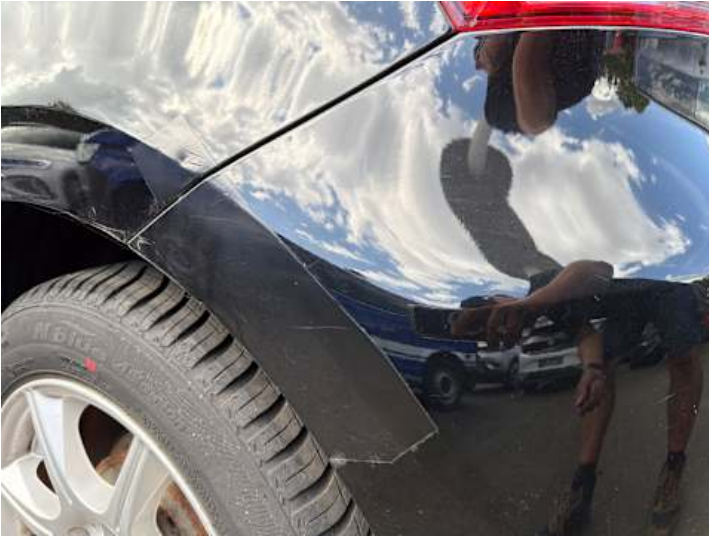
Stoßstange hinten (Kratzer, Unsachgemäß instand gesetzt)
