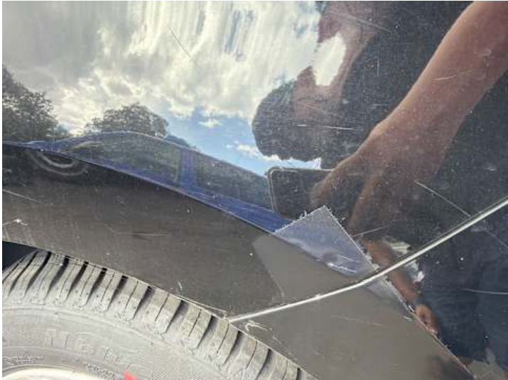
Seitenteil hinten links (Unsachgemäß instand gesetzt, Delle)
