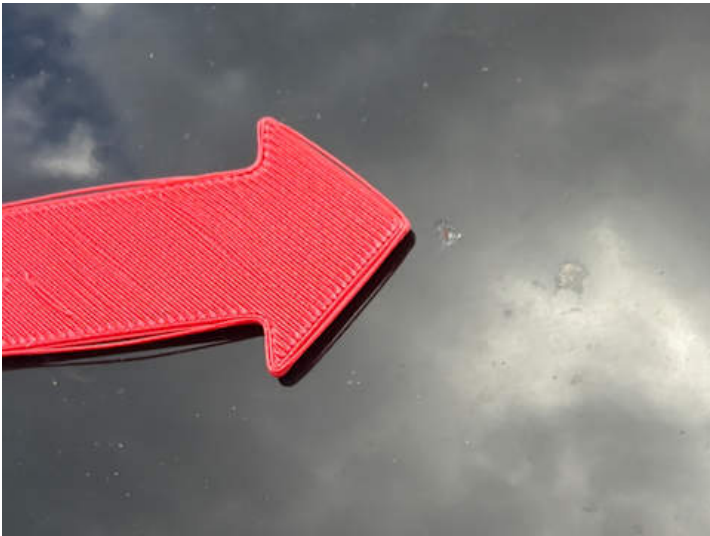
Motorhaube (Steinschlag, Rost)
