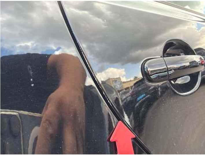
Türe hinten rechts (Kratzer, Lackschaden)
