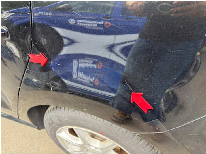
Seitenteil hinten links (Unsachgemäß instand gesetzt, Delle)
