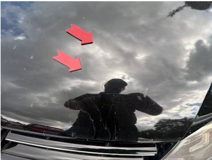
Motorhaube (Steinschlag, Rost)
