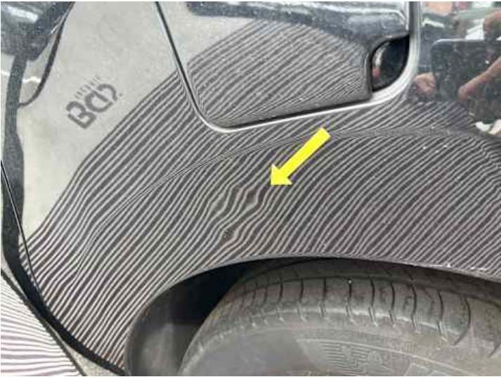
Seitenteil hinten links (Verformung)
