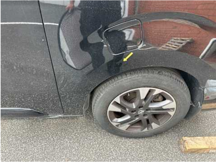
Seitenteil hinten links (Verformung)
