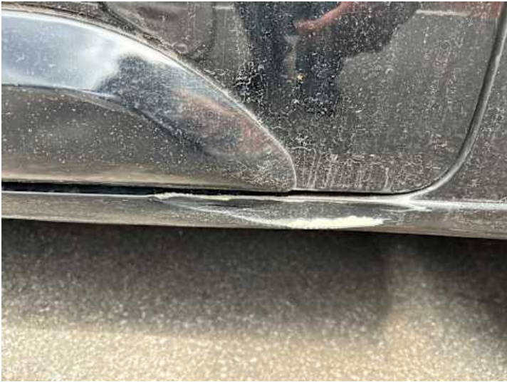
Schweller links (Verformung, Lackschaden)
