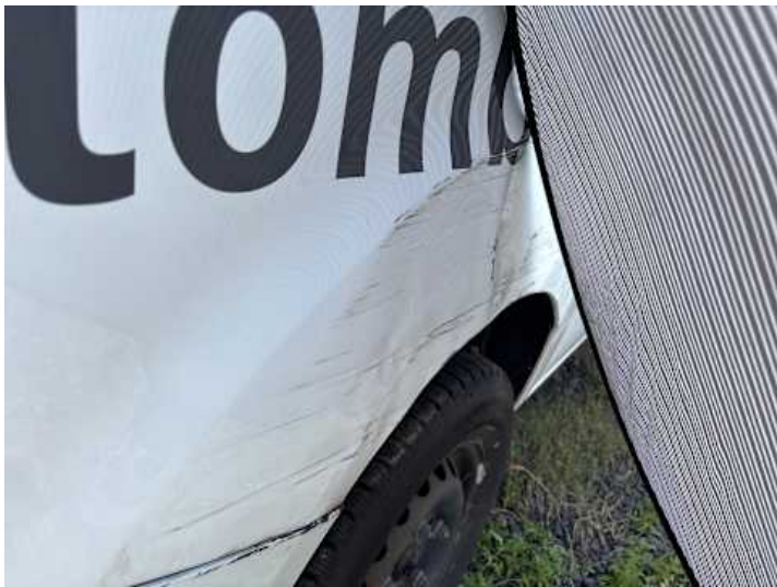
Seitenteil hinten rechts (Delle, Lackschaden)
