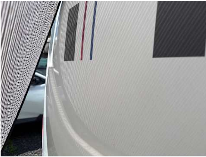
Heckklappe (Delle, Lackschaden)
