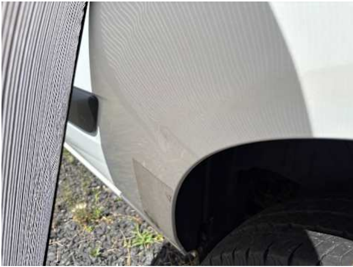
Seitenteil hinten links (Delle, Lackschaden, Kratzer)
