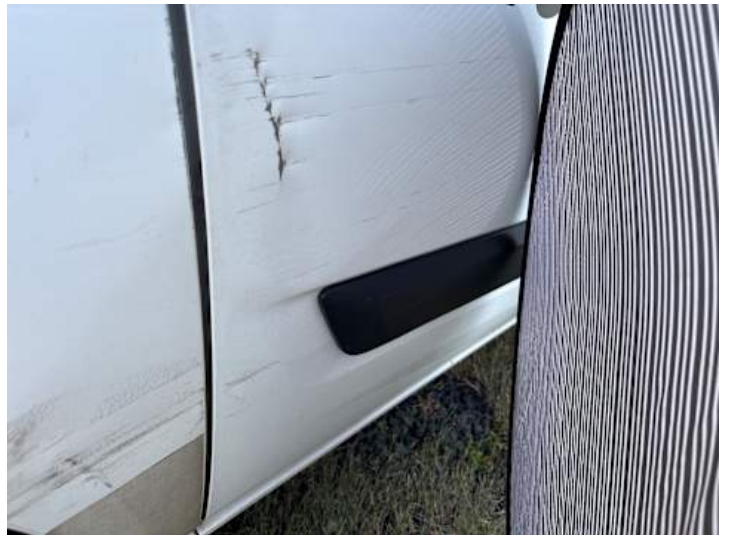
Türe hinten rechts (Delle, Lackschaden)
