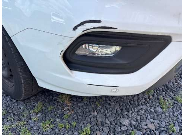
Stoßstange vorne (Lackschaden, Verformung)
