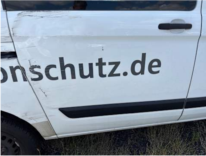
Türe hinten rechts (Delle, Lackschaden)
