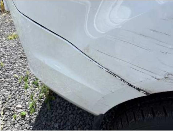
Stoßstange hinten (Spaltmaße ungenau, Lackschaden)
