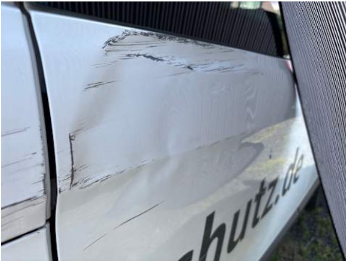
Türe hinten rechts (Delle, Lackschaden)
