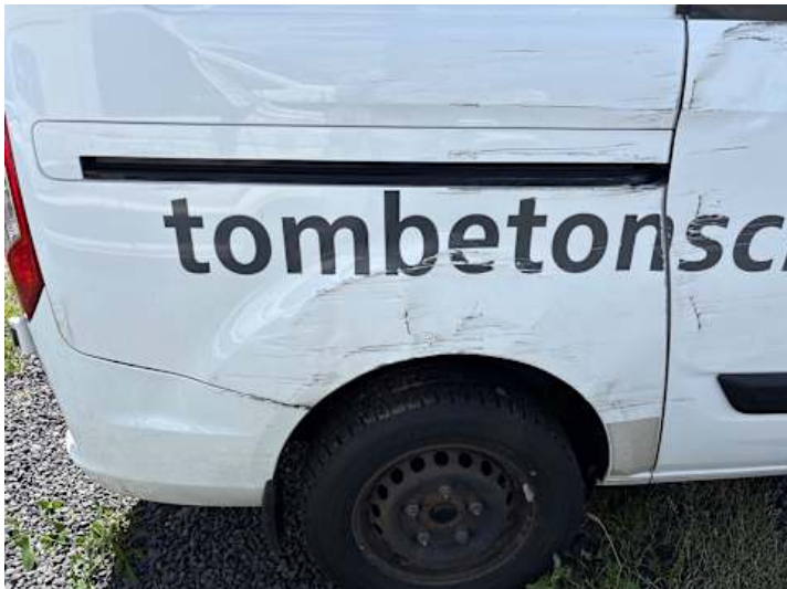
Seitenteil hinten rechts (Delle, Lackschaden)
