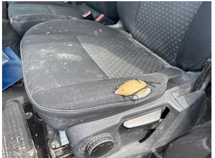
Innenraum (Riss/Bruch, Verschleiß, Verschmutzung)
