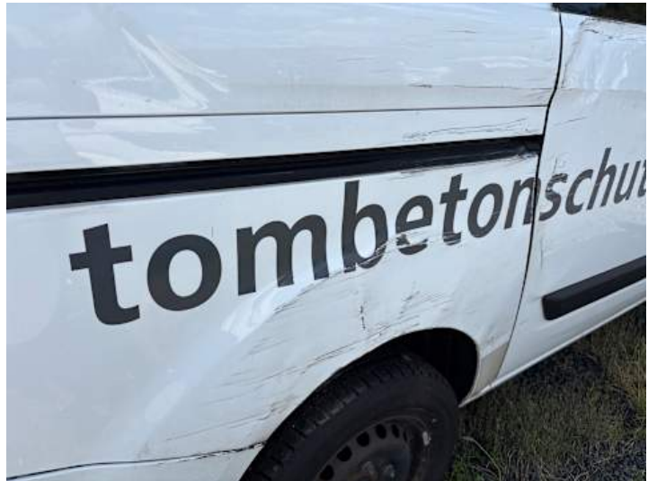
Seitenteil hinten rechts (Delle, Lackschaden)
