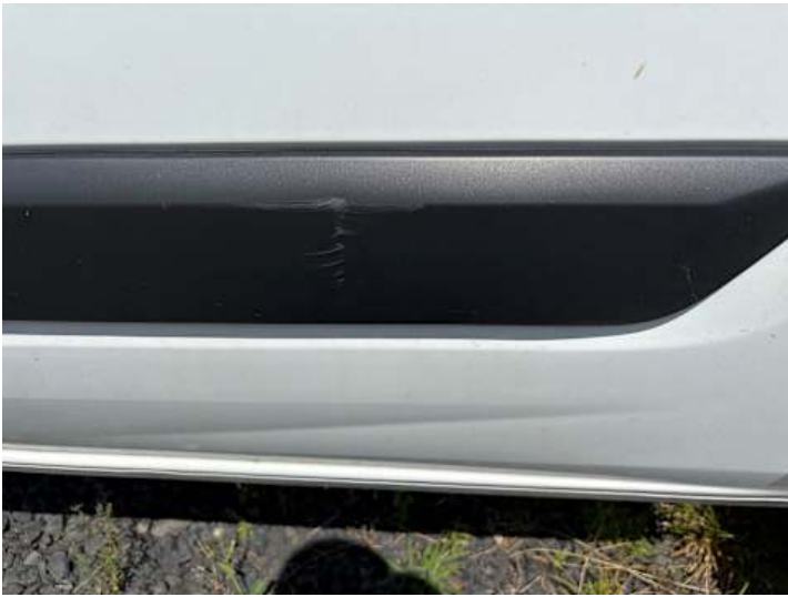
Seitenteil hinten links (Delle, Lackschaden, Kratzer)
