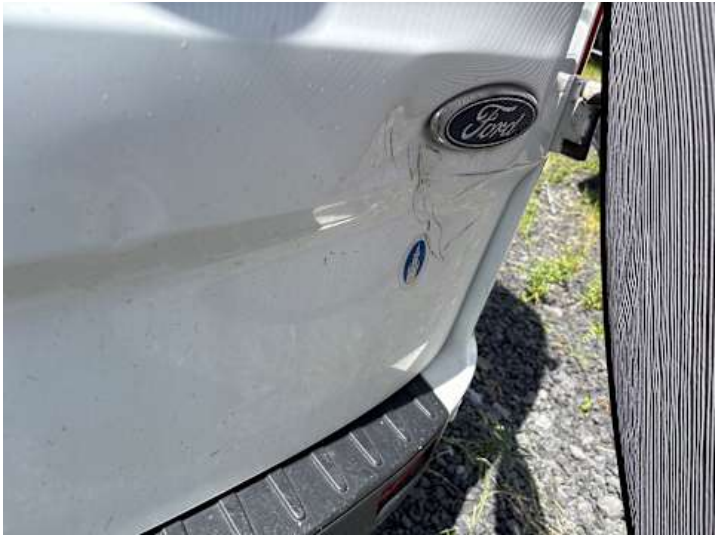
Heckklappe (Delle, Lackschaden)
