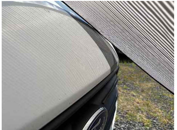
Motorhaube (Delle, Lackschaden)
