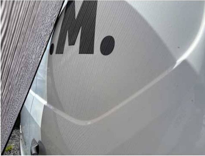
Heckklappe (Delle, Lackschaden)
