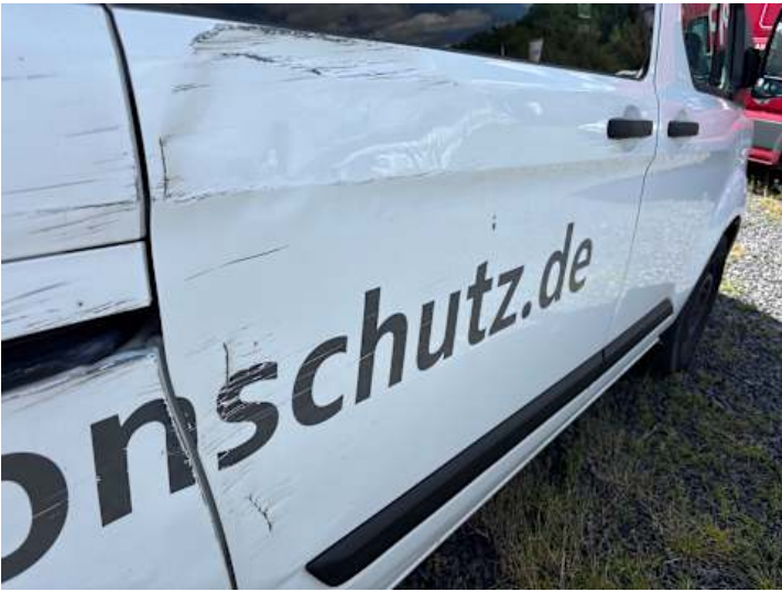
Türe hinten rechts (Delle, Lackschaden)
