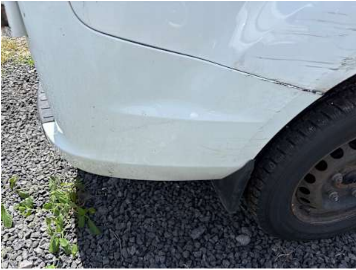
Stoßstange hinten (Spaltmaße ungenau, Lackschaden)
