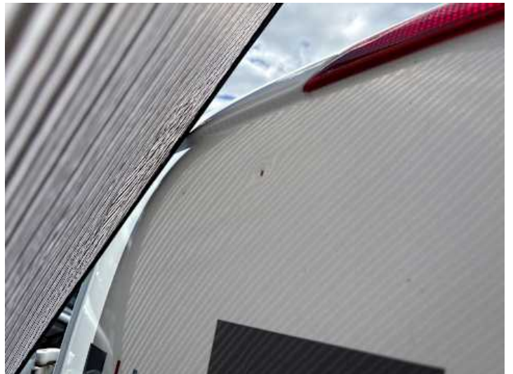
Heckklappe (Delle, Lackschaden)
