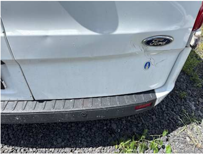
Heckklappe (Delle, Lackschaden)
