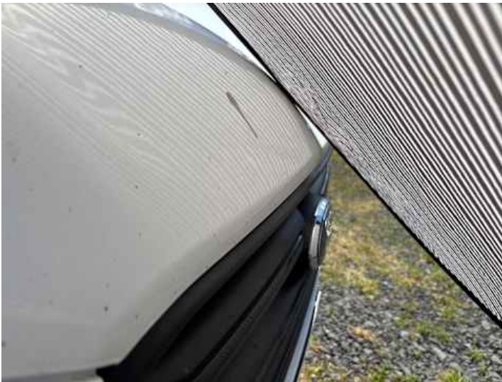
Motorhaube (Delle, Lackschaden)
