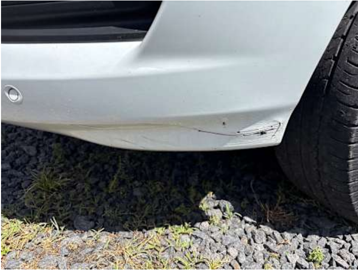
Stoßstange vorne (Lackschaden, Verformung)
