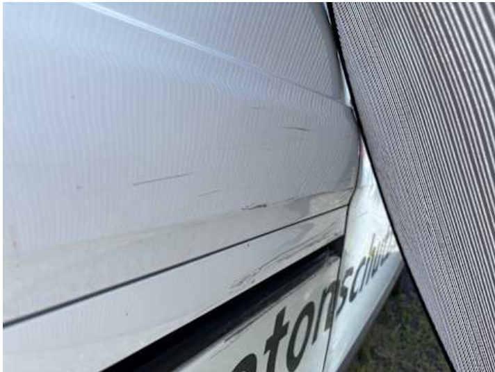
Seitenteil hinten rechts (Delle, Lackschaden)
