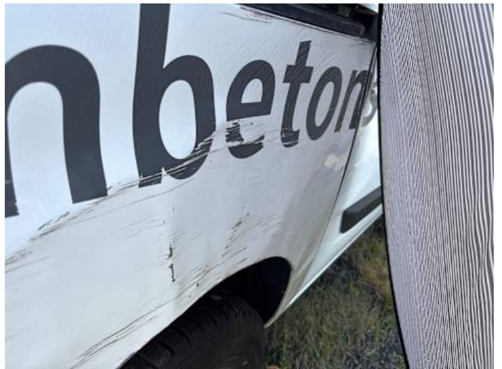
Seitenteil hinten rechts (Delle, Lackschaden)
