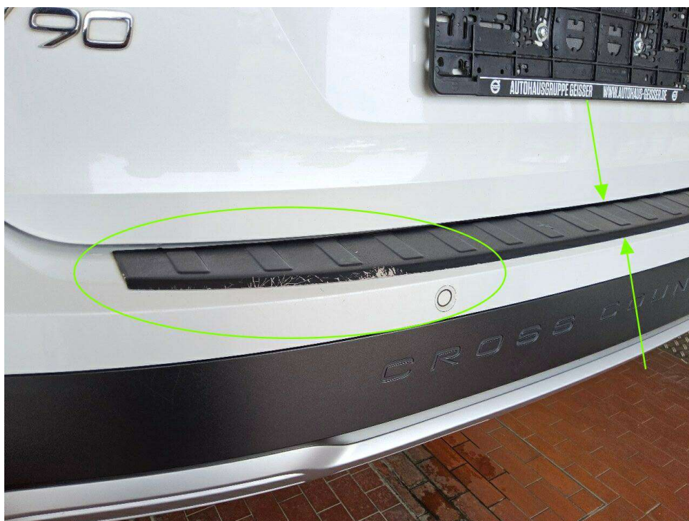
Bild 10 : Stoßfänger hinten leichte Kratzer und Ladekantenschutz nachgerüstet, entfernen reinigen und polieren
