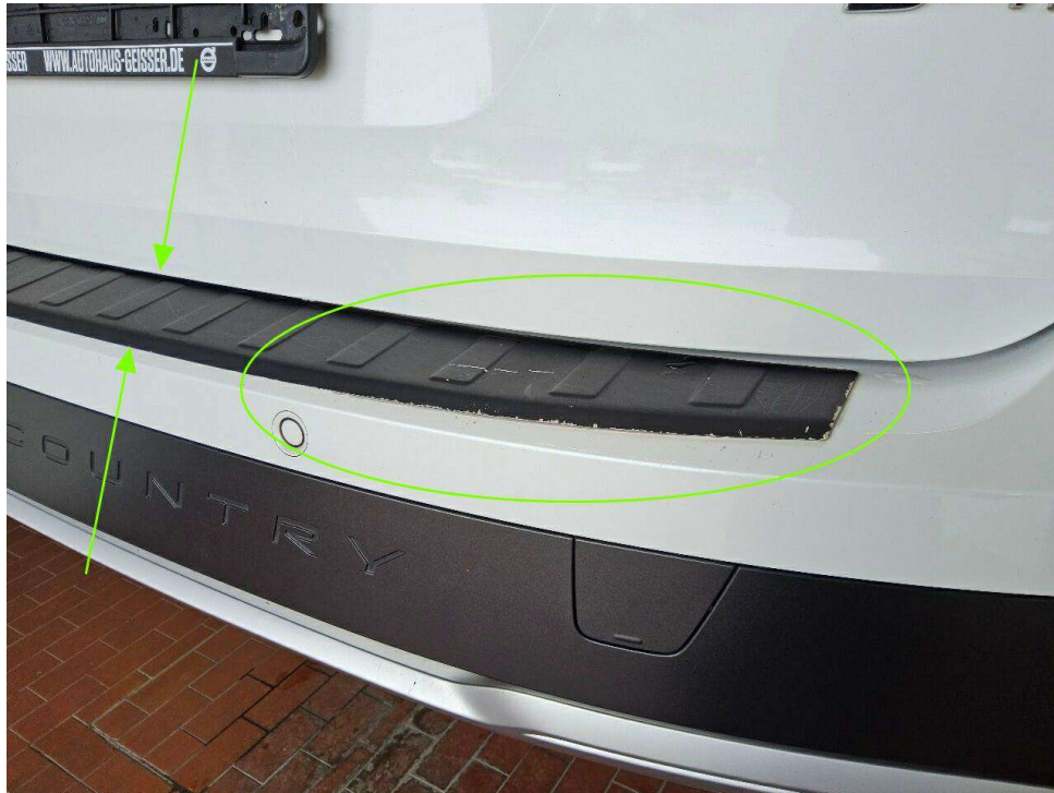
Bild 11 : Stoßfänger hinten leichte Kratzer und Ladekantenschutz nachgerüstet, entfernen reinigen und polieren
