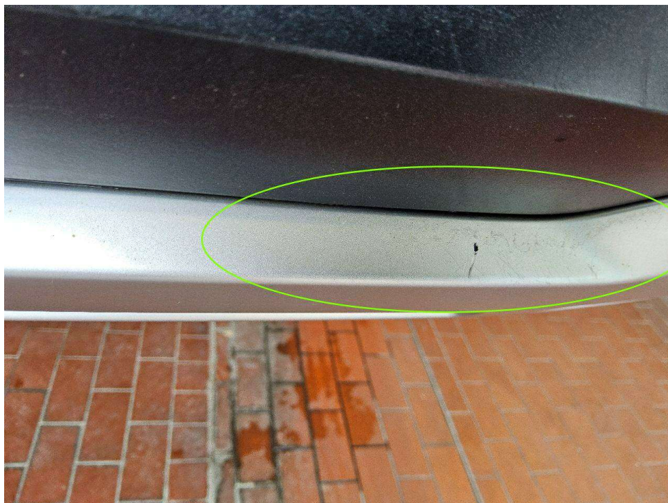
Bild 14 : Diffusor hinten silber matt lackiert Druckstellen und Kratzer
