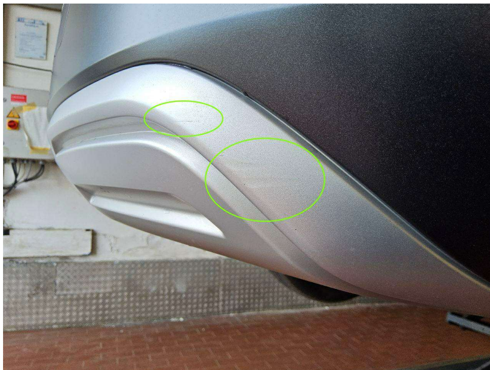
Bild 13 : Diffusor hinten silber matt lackiert Druckstellen und Kratzer
