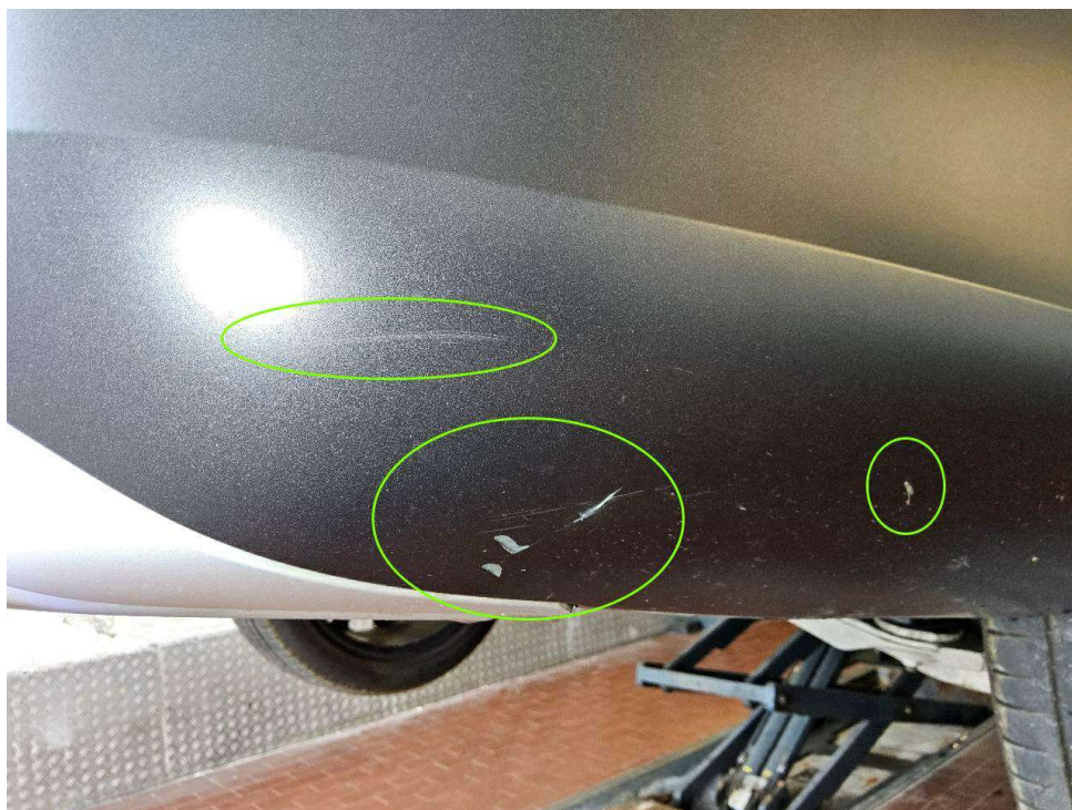
Bild 12 : Stoßfängermittelteil matt lackiert rechts verschrammt
