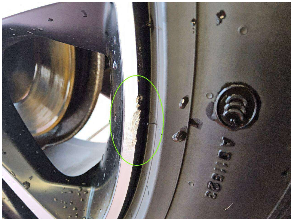
Bild 8 : Felge glanzgedreht hinten rechts verschrammt - Wertminderung
