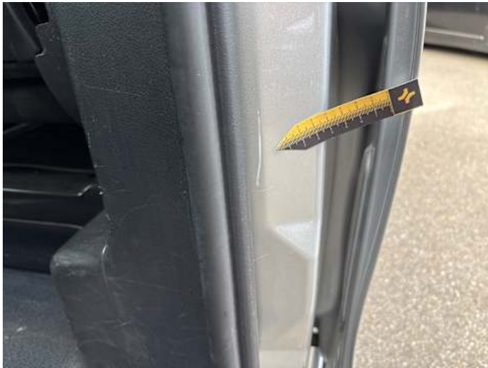
Türe hinten rechts (Kratzer, Lackschaden)
