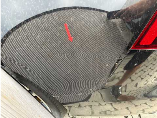
Seitenteil hinten links (Verformung, Kratzer)
