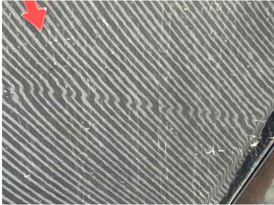
Seitenteil hinten links (Verformung, Kratzer)
