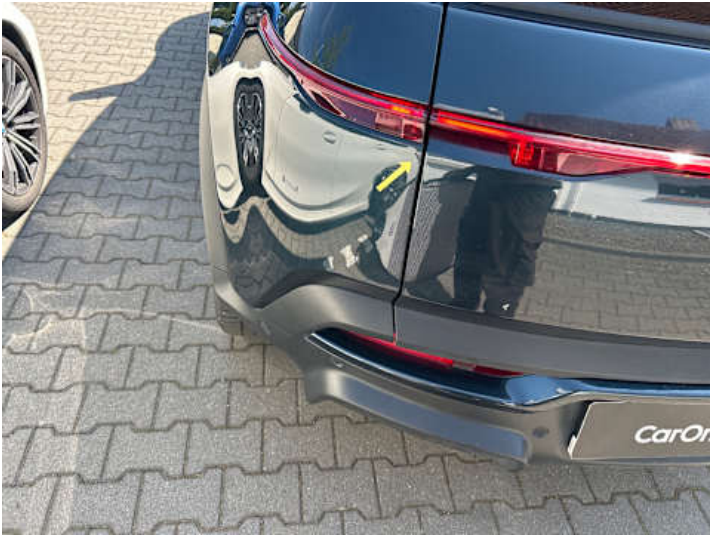
Seitenteil hinten links (Lackschaden)
