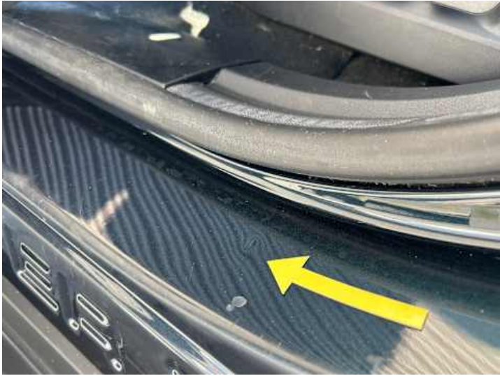
Schweller links (Delle)
