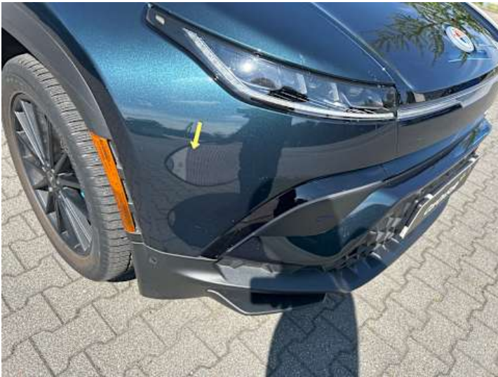
Kotflügel vorne rechts (Kratzer, Lackschaden)
