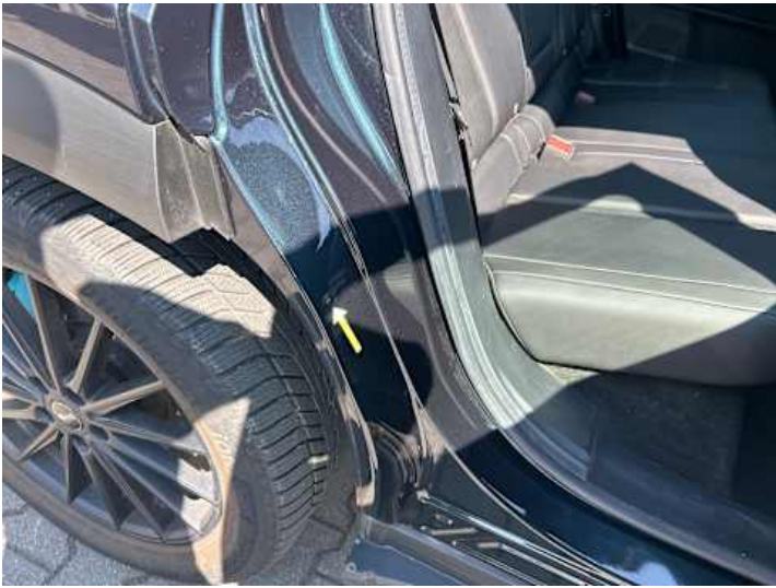
Seitenteil hinten rechts (Lackschaden)
