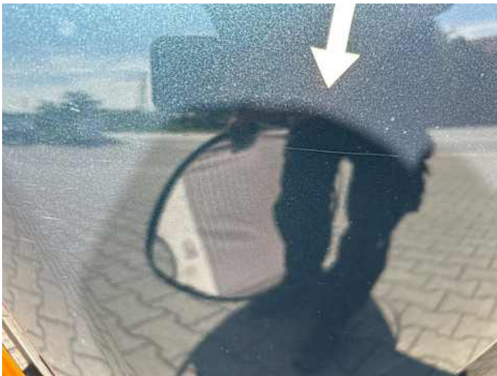
Kotflügel vorne rechts (Kratzer, Lackschaden)
