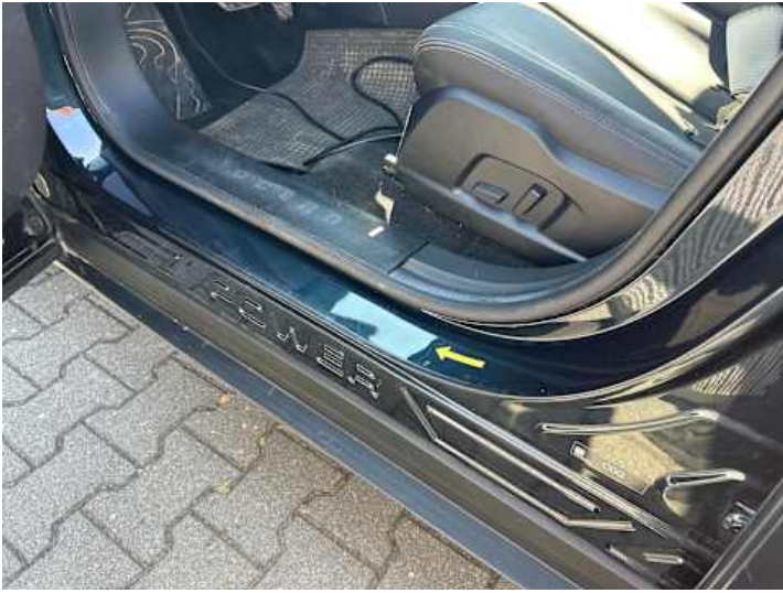
Schweller links (Delle)
