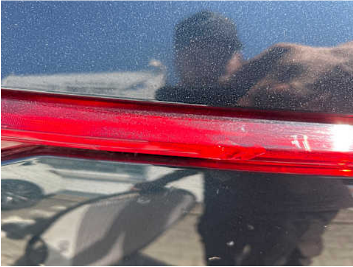
Rücklicht (links) (Riss/Bruch)
