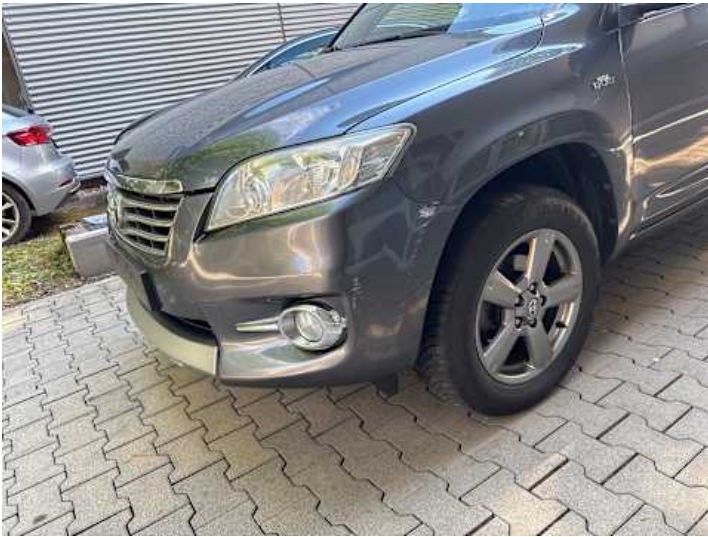
Stoßstange vorne (Lackschaden, Kratzer)
