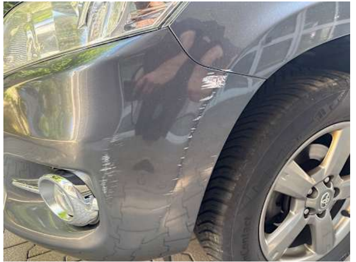
Stoßstange vorne (Lackschaden, Kratzer)
