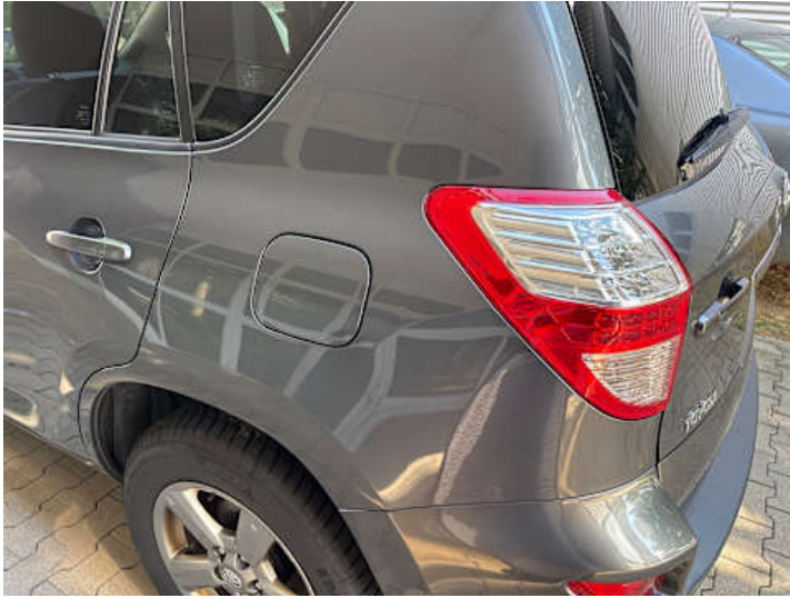
Seitenteil hinten links (Verformung)
