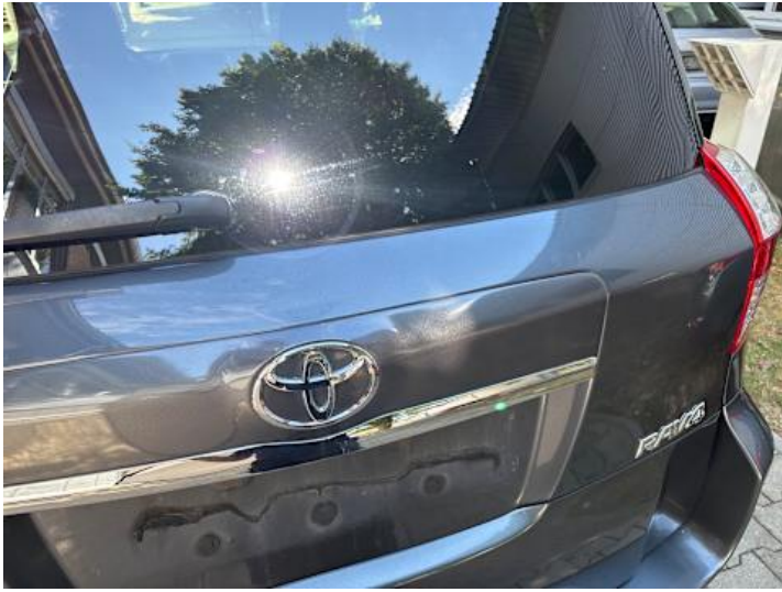
Heckklappe (Lackschaden, Kratzer)
