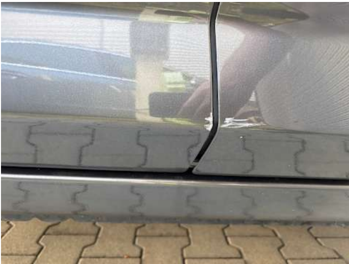
Türe hinten rechts (Lackschaden, Kratzer)
