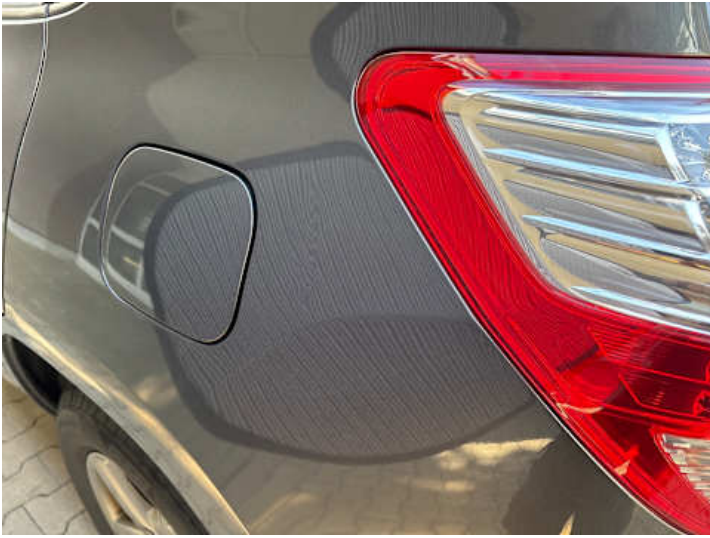
Seitenteil hinten links (Verformung)
