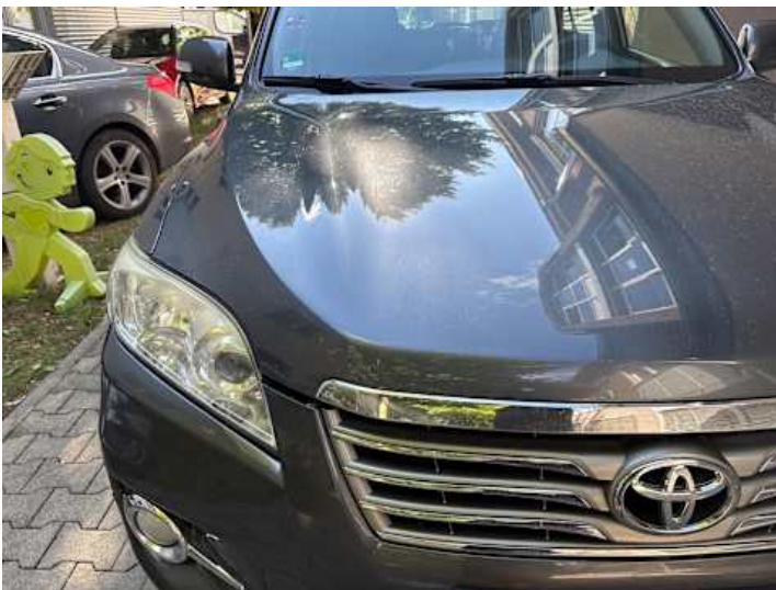
Motorhaube (Delle, Lackschaden)
