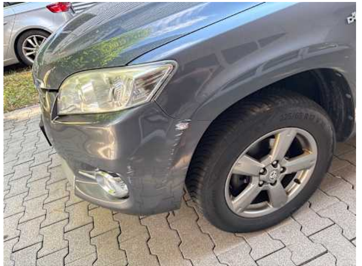
Kotflügel vorne links (Lackschaden, Kratzer)
