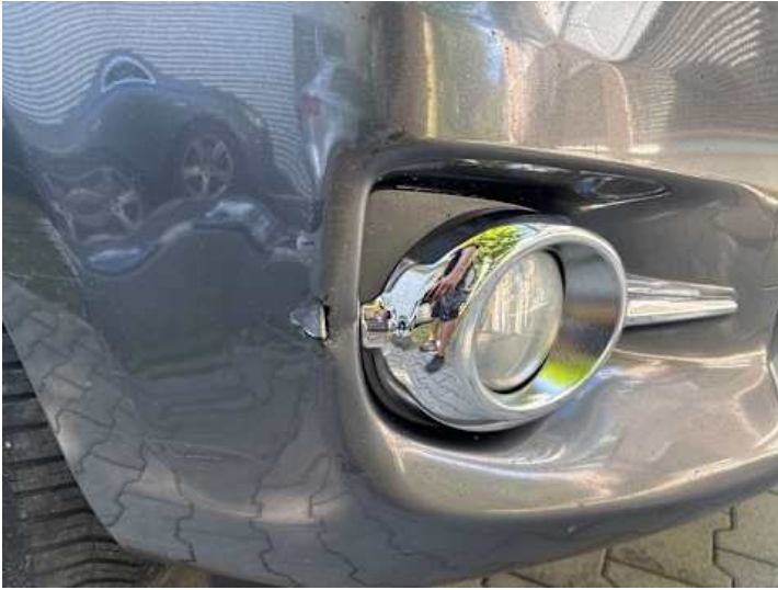
Kotflügel vorne links (Kratzer, Lackschaden, Riss/Bruch)
