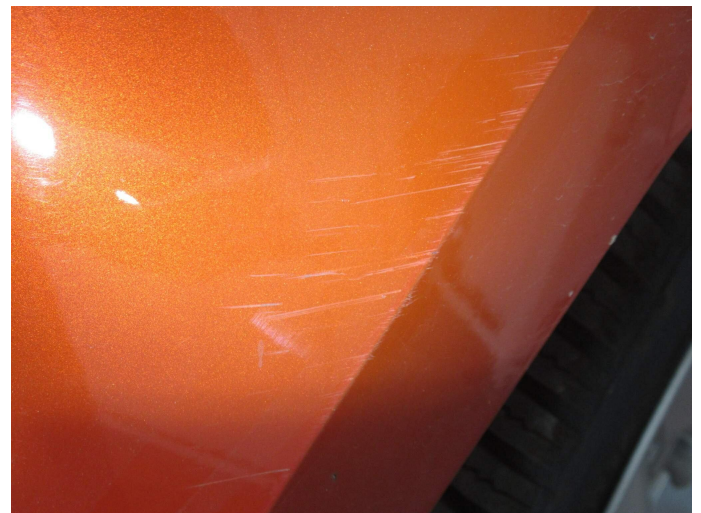
Bild 8: Außen, Stoßfänger hinten, zerkratzt, Fehlstellung, smart repair, prüfen (Schadenerweiterung möglich)
