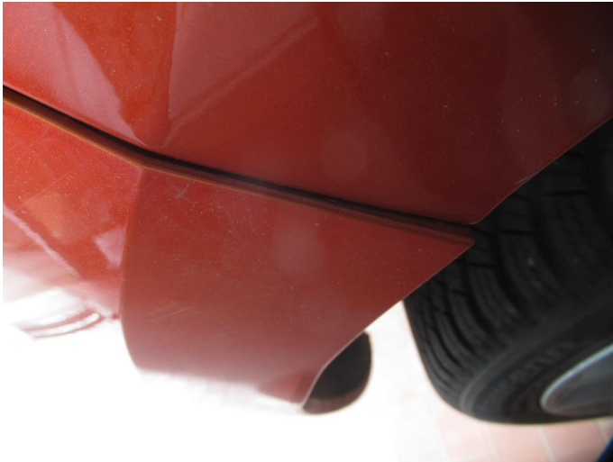
Bild 9: Außen, Stoßfänger hinten, zerkratzt, Fehlstellung, smart repair, prüfen (Schadenerweiterung möglich)
