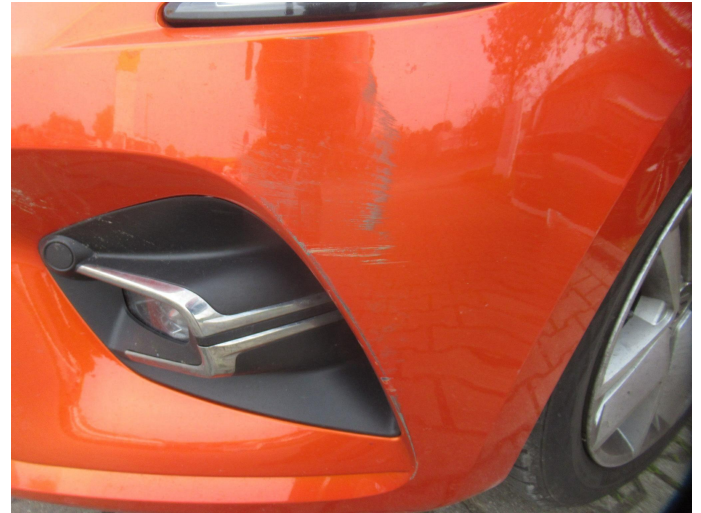
Bild 6: Außen, Stoßfänger vorne - Lackierung, verschrammt, lackieren mit Lackaufbau
