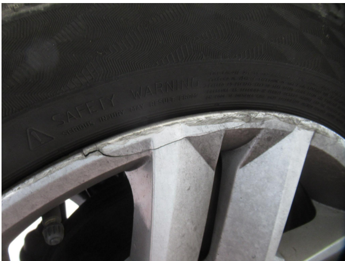
Bild 3: Außen, Felge vorne rechts - Radzierdeckel, zerbrochen, erneuern
