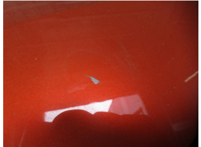
Bild 10: Außen, Heckdeckel - Lackierung, verschrammt, smart repair
