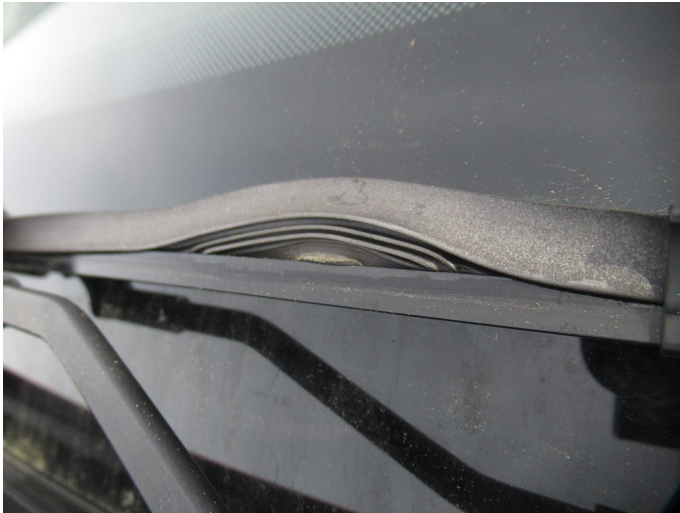
Bild 5: Technik, Wischerblätter vorn, verformt, erneuern
