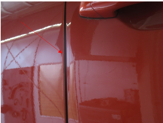
Bild 7: Außen, Tür vorne rechts, deformiert, instandsetzen und lackieren mit Lackaufbau
