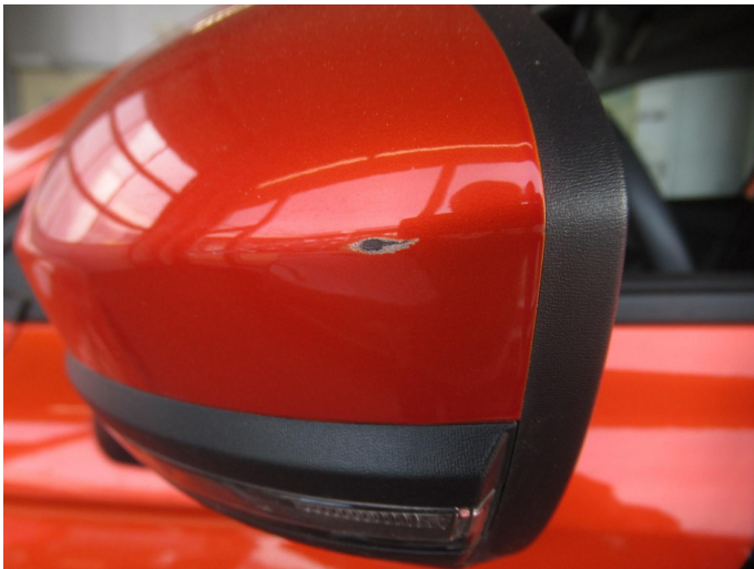
Bild 11: Außen, Außenspiegel links - Lackierung, verschrammt, smart repair
