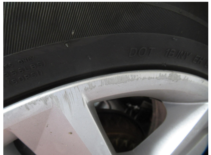
Bild 4: Außen, Felge hinten rechts - Radzierdeckel, zerkratzt, erneuern
