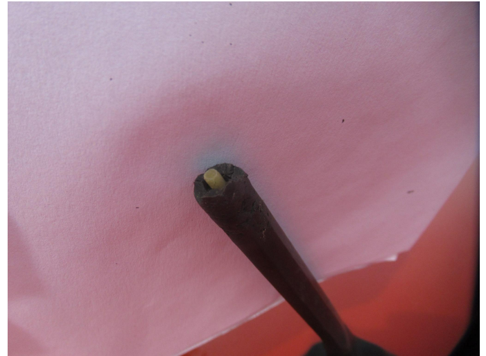
Bild 2: Technik, Antennenstab , Tierversbiss, erneuern
