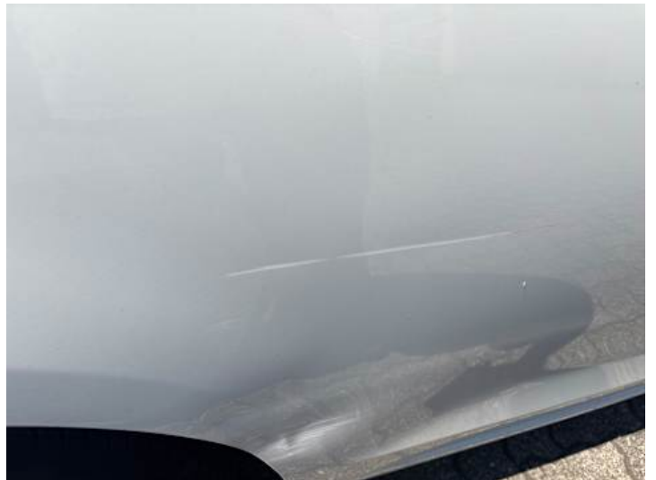
Seitenteil hinten rechts (Verformung, Kratzer)
