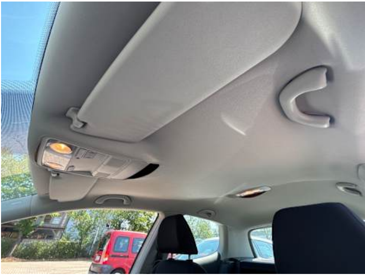
Innenraum (Anderer Schaden): Dachhimmel hängt
