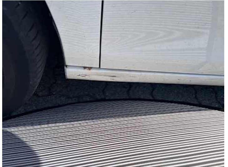
Schweller links (Verformung, Rost)
