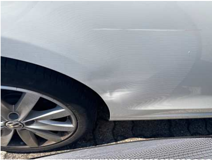
Seitenteil hinten rechts (Verformung, Kratzer)
