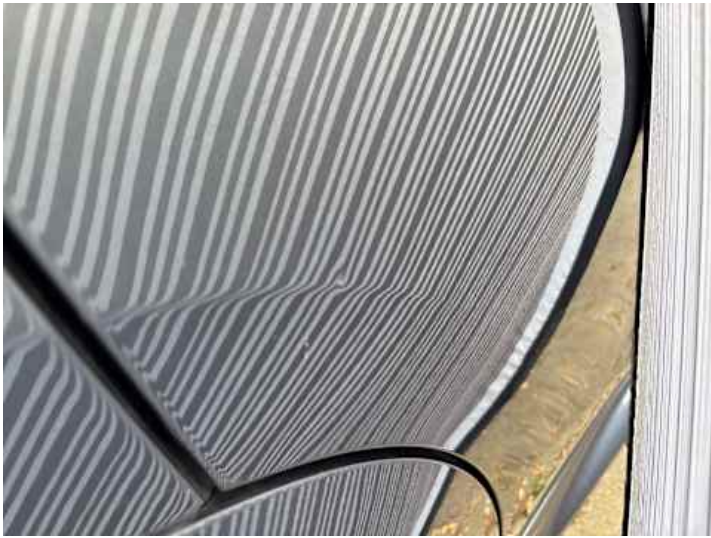
Türe hinten rechts (Delle, Kratzer)
