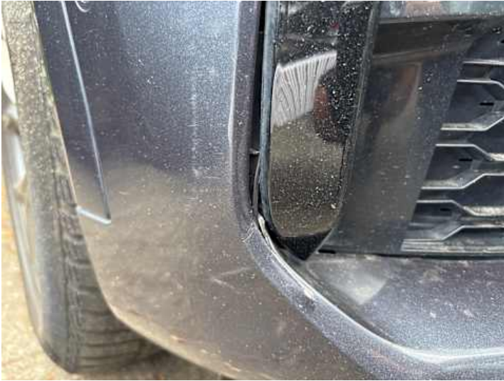
Stoßstange vorne (Riss/Bruch)
