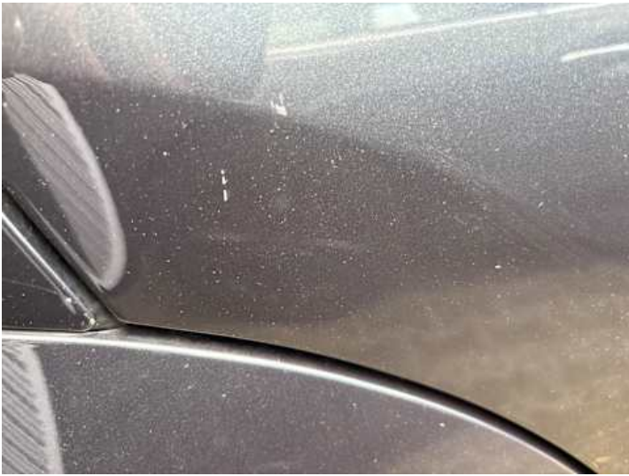
Türe hinten rechts (Delle, Kratzer)
