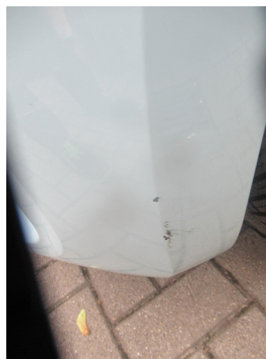
Bild 2: Außen, Stoßfänger vorne, verschrammt, lackieren
