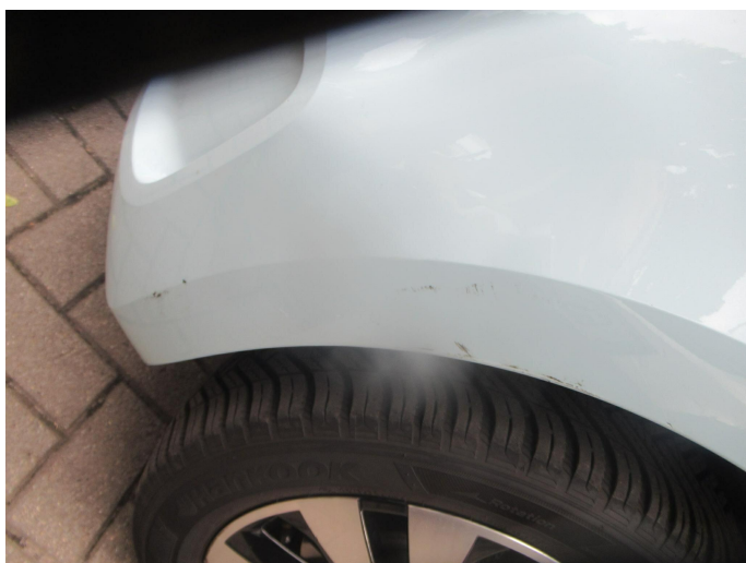
Bild 1: Außen, Stoßfänger vorne, verschrammt, lackieren
