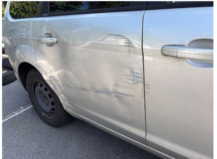
Türe hinten rechts (Kratzer, Lackschaden, Verformung, Anderer Schaden): Tür öffnet nicht !
