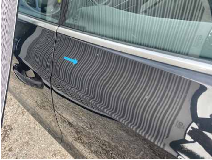
Seitenteil hinten links (Delle)
