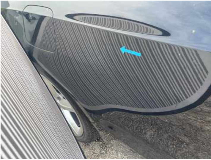
Seitenteil hinten rechts (Delle)
