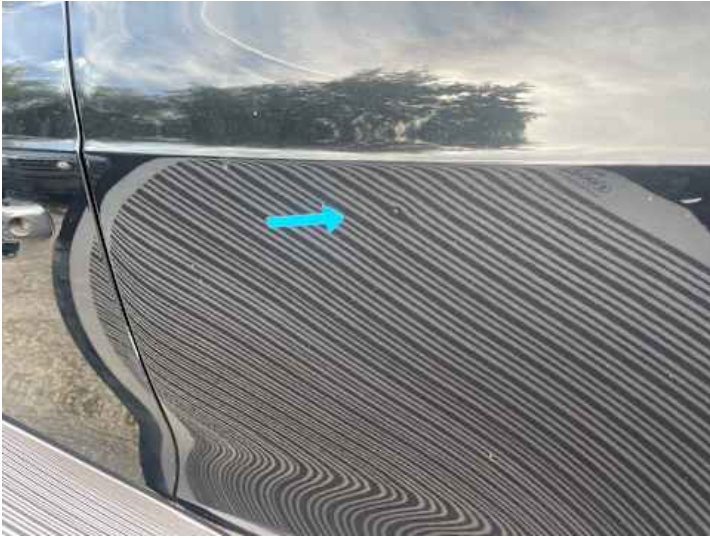
Seitenteil hinten links (Delle)
